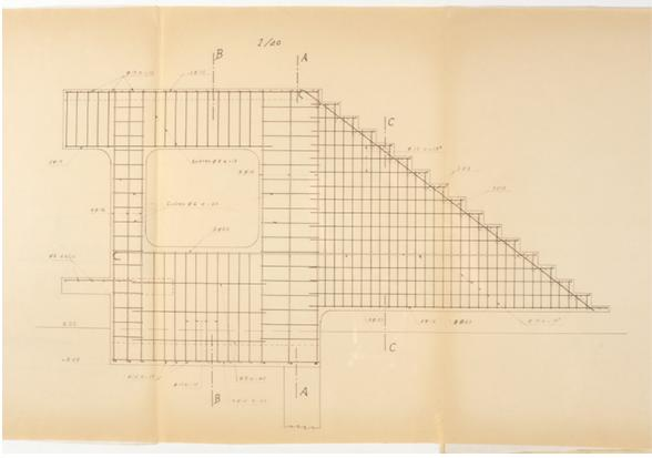
Cahier de coffrage et armature de la structure de l'escalier, s.d.
