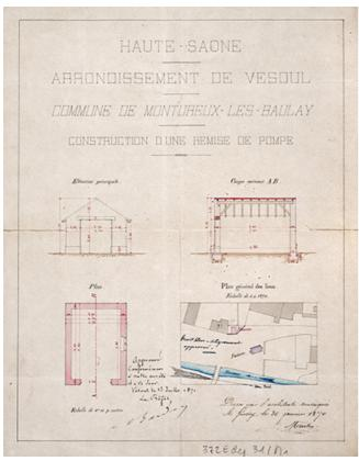
Projet de construction d'une rémise à pompe (1870).
