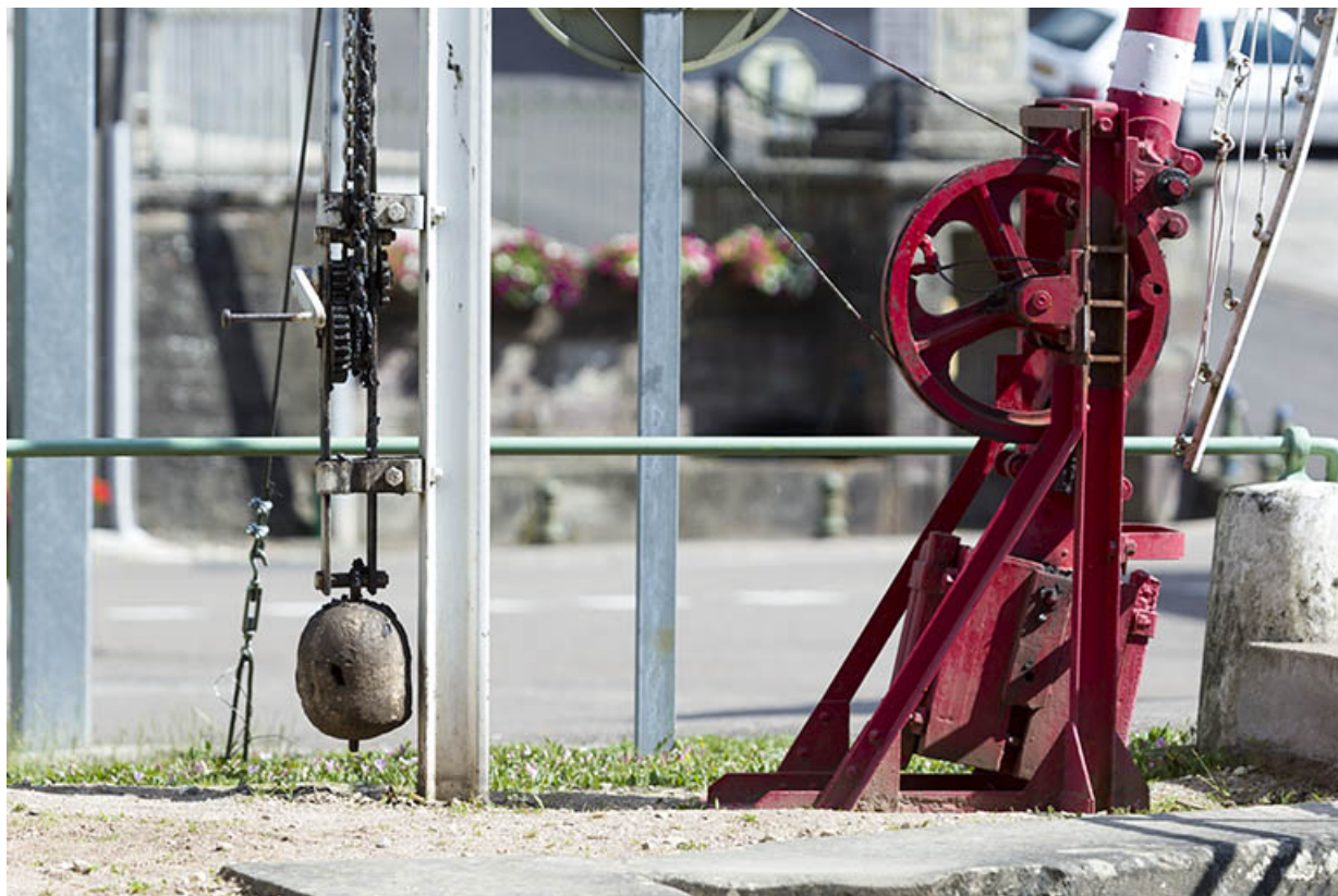
Détail du mécanisme de la barrière.
