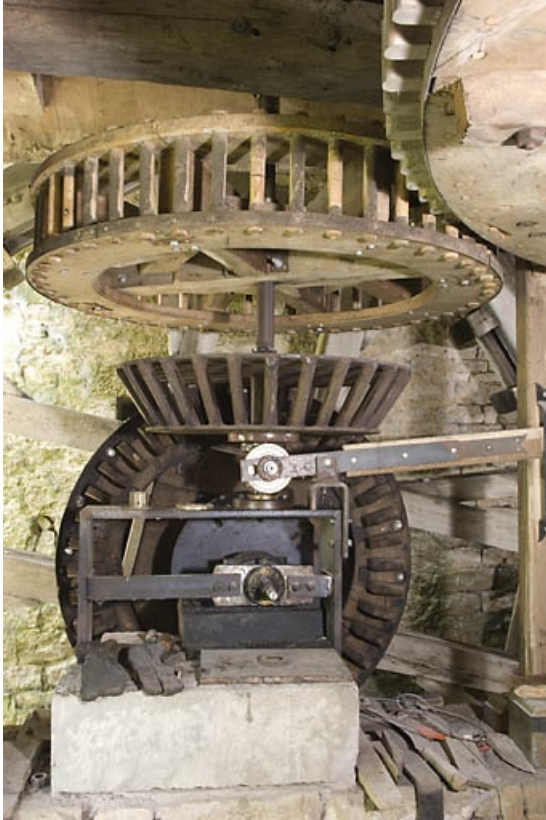
Détail des éléments de transmission (roues dentées et lanternes). 70, Fondremand, lieudit : le Moulin
