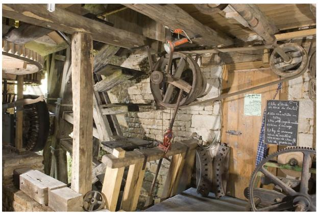
Atelier de fabrication. Roue hydraulique et transmissions.
