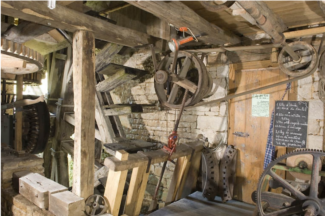
Atelier de fabrication. Roue hydraulique et transmissions.
