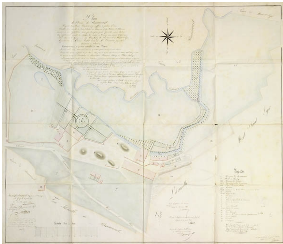
Plan de l'usine de Renaucourt composée d'un haut fourneau avec soufflerie à pistons, de 2 patouillets [...], appartenant à Mme Rochet veuve de M. Dornier.
