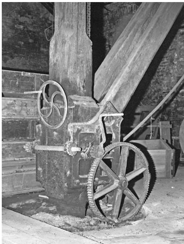
Base de la grue à potence.
