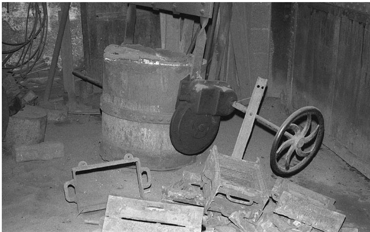
Châssis et poche de coulée.
