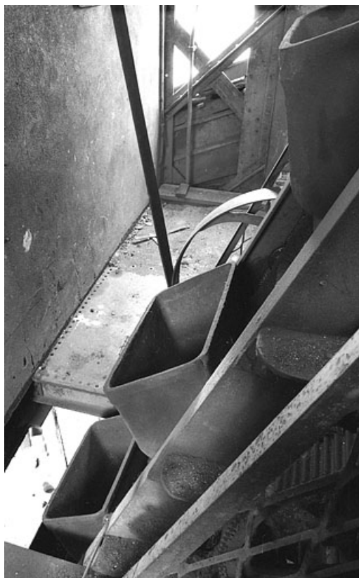
Détail du chargeur à godets du grand cubilot.
