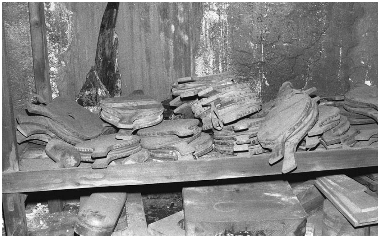
Soufflets de mouleurs (nettoyage des moules).
