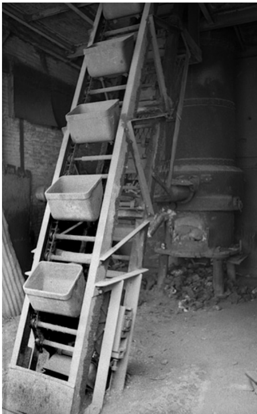
Chargeur à godets du grand cubilot (5 tonnes). 70, Arc-lès-Gray, 5 rue de Verdun
