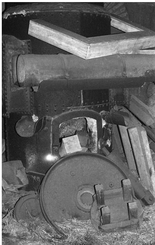
Base du petit coulée cubilot (3,5 tonnes).
