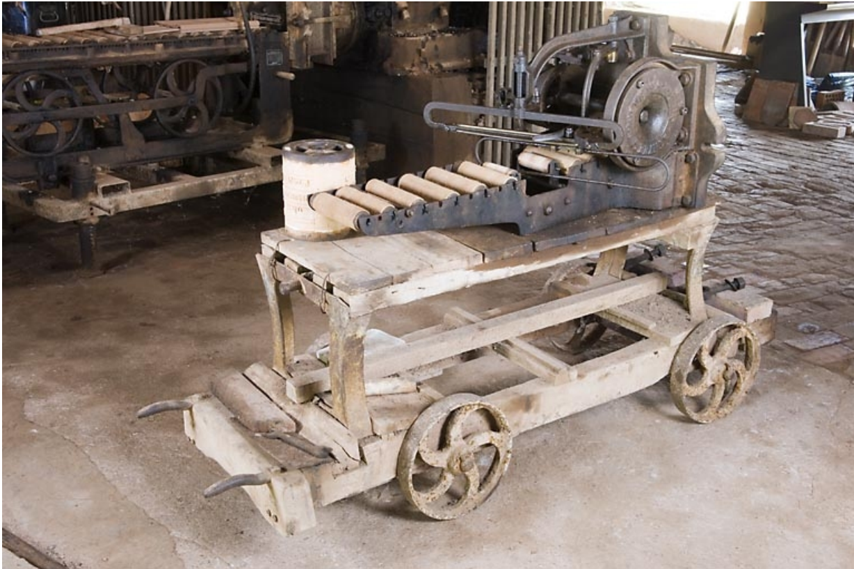
Mouleuse-étireuse pour tuiles sur son chariot découpeur.
