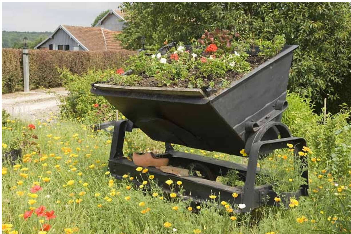
Wagonnet à bascule (transport de la terre).
