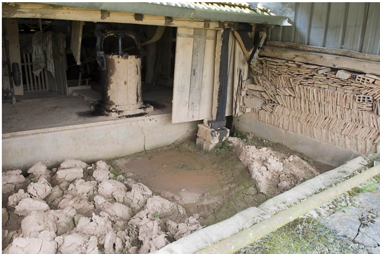
Fosse de "repos" et de malaxage de la terre.
