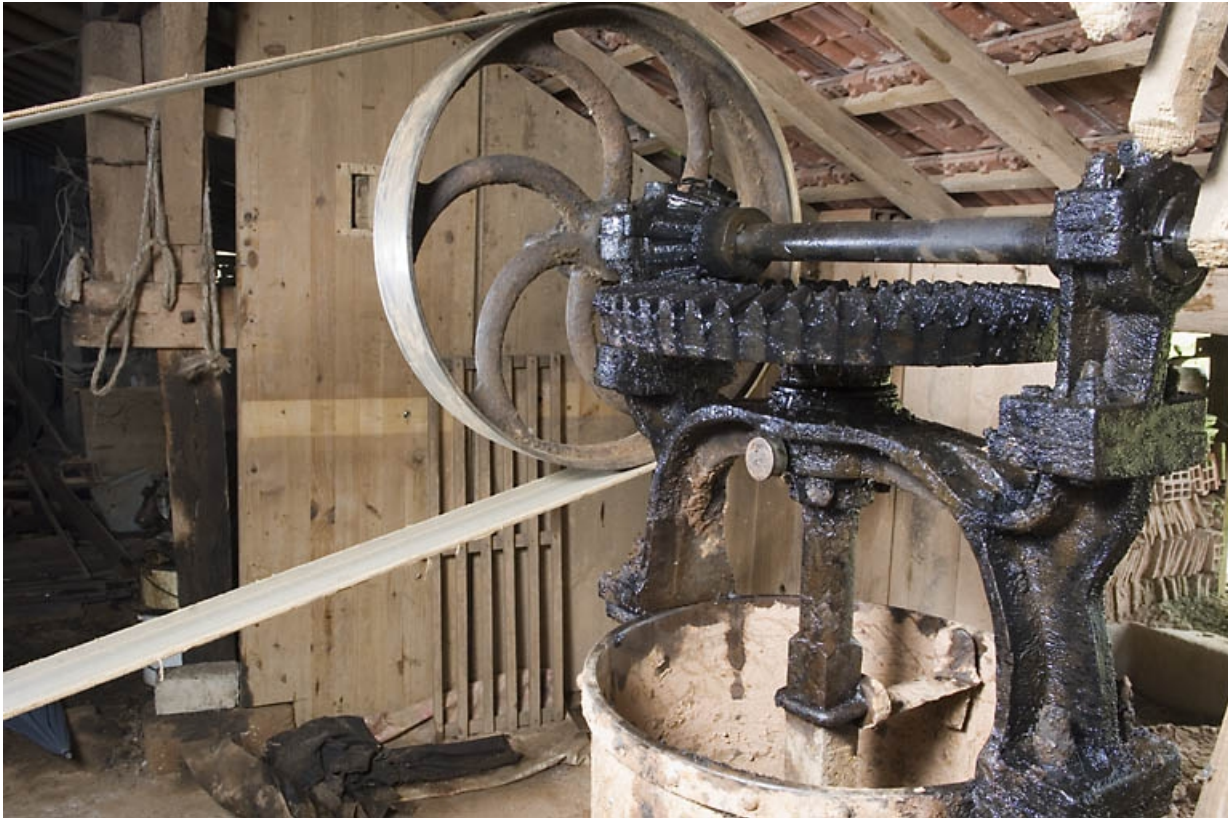
Partie supérieure du malaxeur. Transmission par courroie et engrenages.
