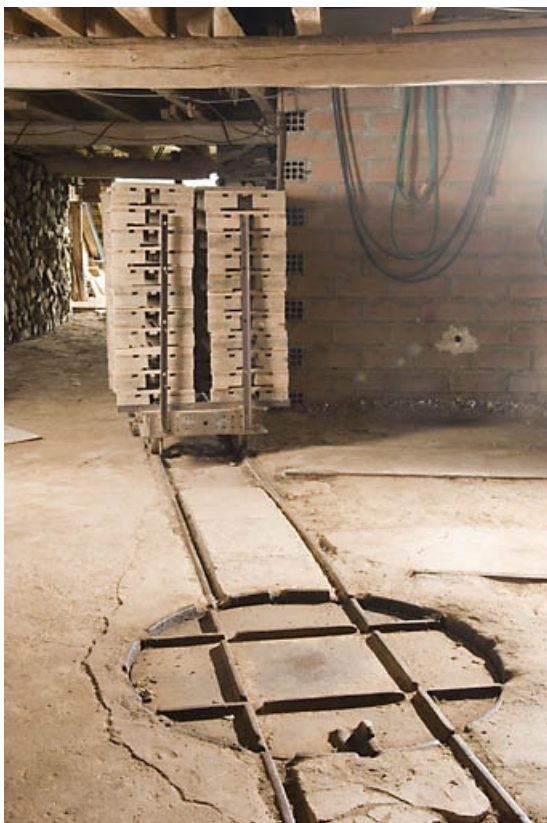
Wagonnet à plateaux sur voie Decauville.
