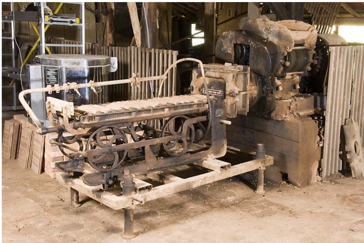
Mouleuse-étireuse Brandt et broyeur Dubois.
