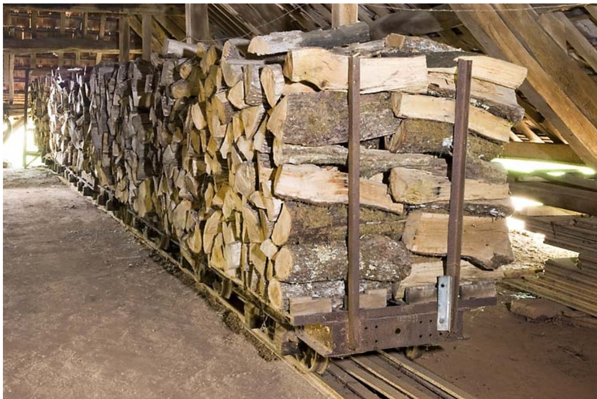
Pièce de séchage. Wagonnets chargés de bois.
