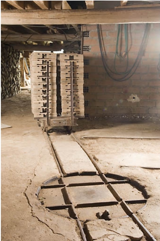
Wagonnet à plateaux sur voie Decauville.
