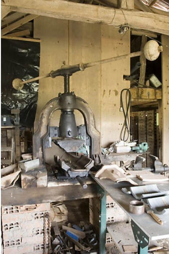
Presse à balancier (pour tuiles faïtières).
