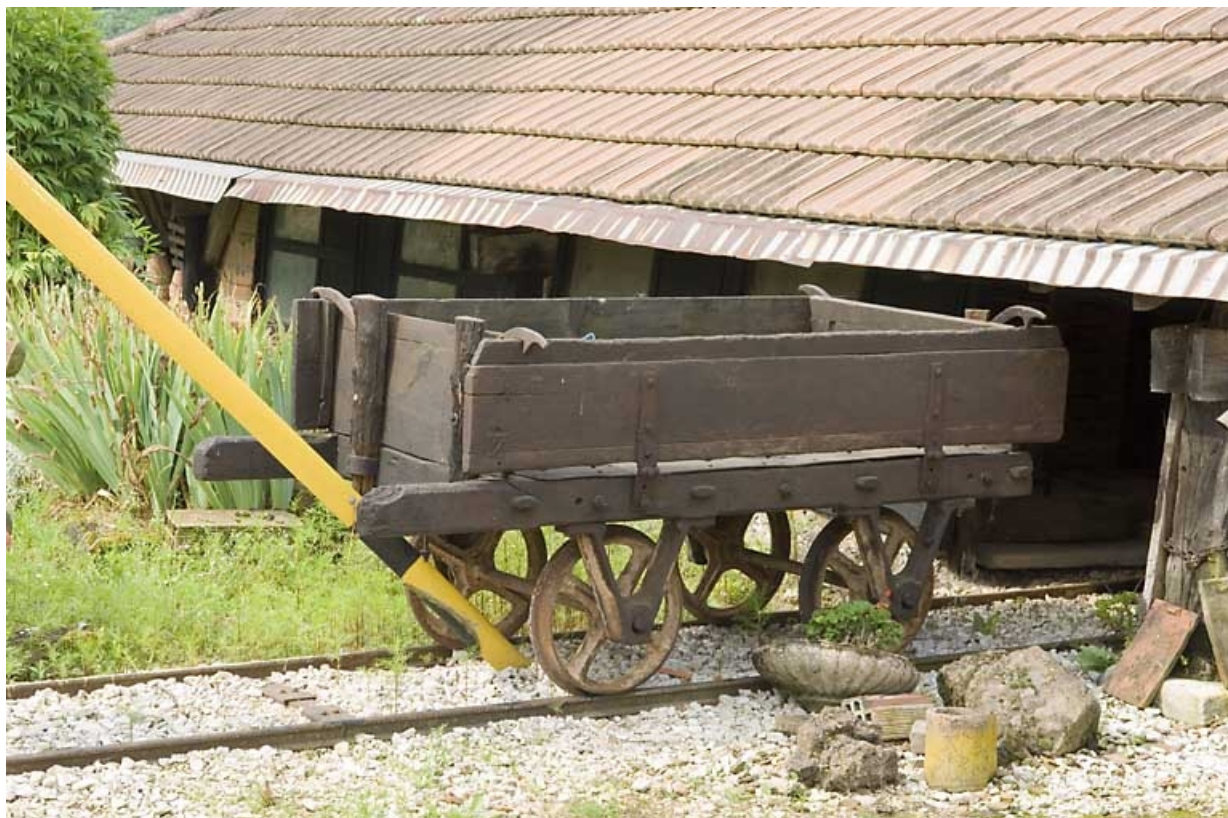
Wagonnet en bois (transport de la terre).
