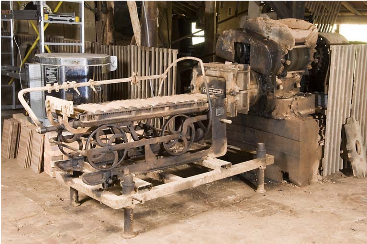
Mouleuse-étireuse Brandt et broyeur Dubois.
