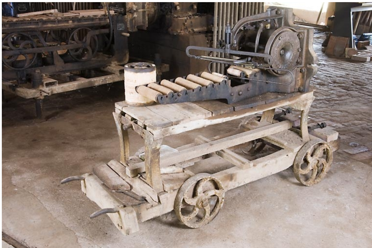
Mouleuse-étireuse pour tuiles sur son chariot découpeur.
