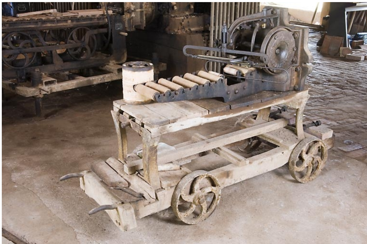
Mouleuse-étireuse pour tuiles sur son chariot découpeur.
