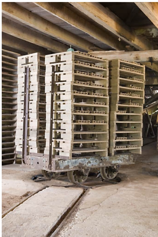
Wagonnet à plateaux sur plaque tournante.
