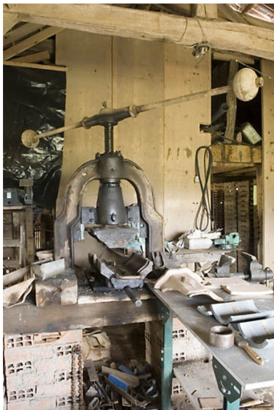
Presse à balancier (pour tuiles faitières).
