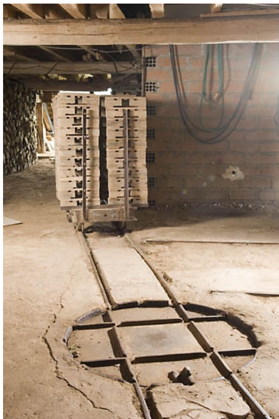
Wagonnet à plateaux sur voie Decauville.
