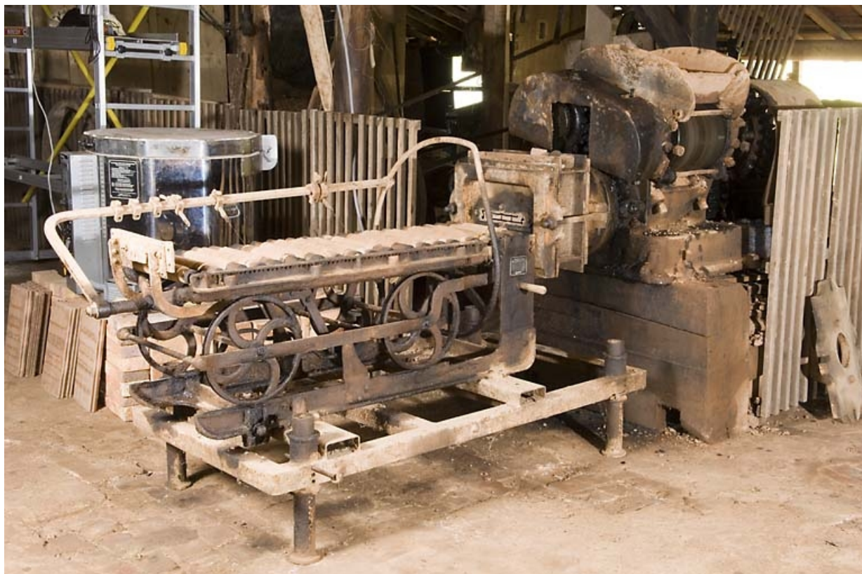
Mouleuse-étireuse Brandt et broyeur Dubois.
