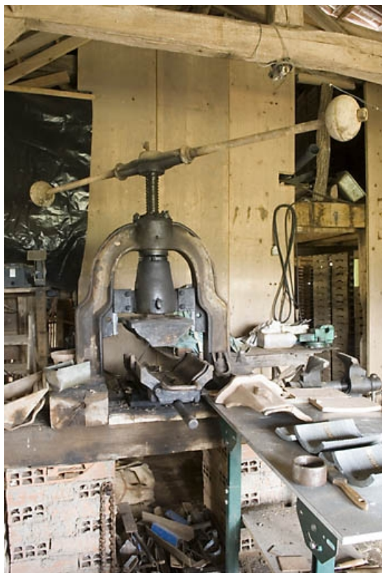
Presse à balancier (pour tuiles faitières).
