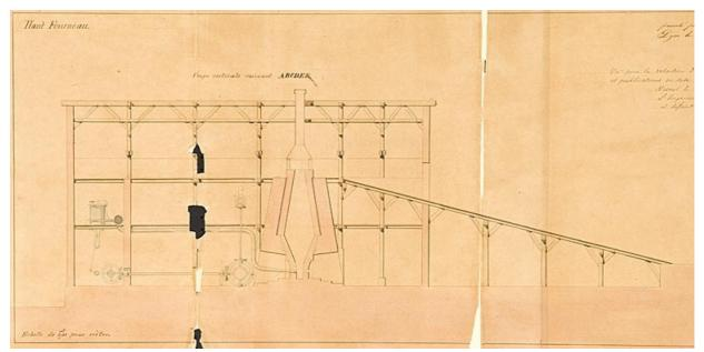
Coupe verticale du batiment et du haut fourneau suivant la ligne brisée.
