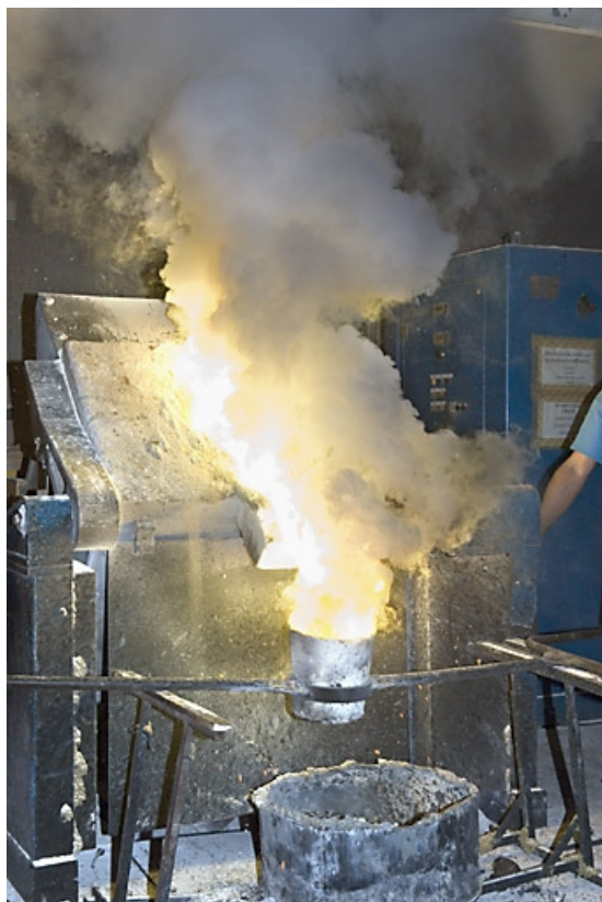
Four électrique. Remplissage de la poche (vue rapprochée). 70, Saint-Sauveur, 44 rue du Maréchal Lyautey
