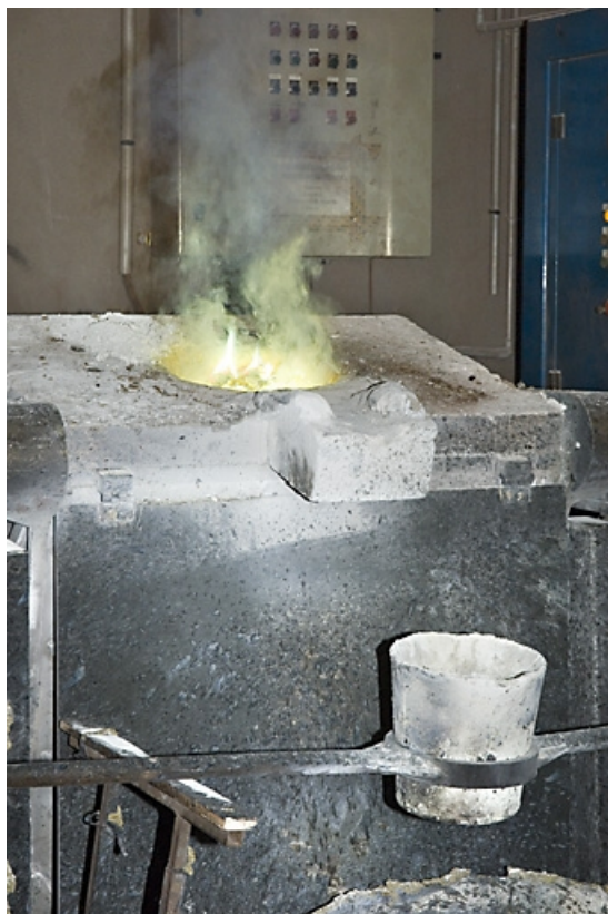
Four électrique. Bascule du four pour la coulée.
