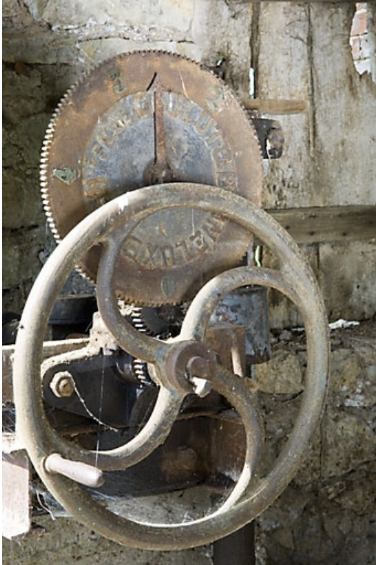
Atelier de scierie. Volant du mécanisme d'admission d'eau de la turbine.
