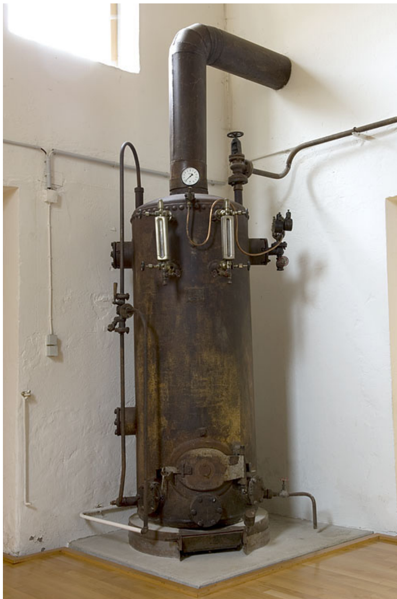
Salle de distillation. Chaudière Thiébaud (Trévillers).
