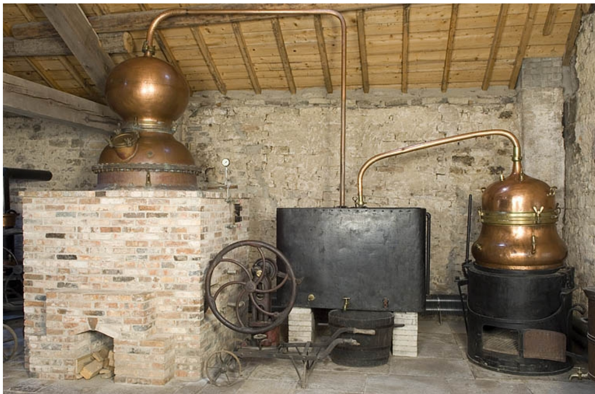
Alambics, chaudières et réfrigérant (au centre).
