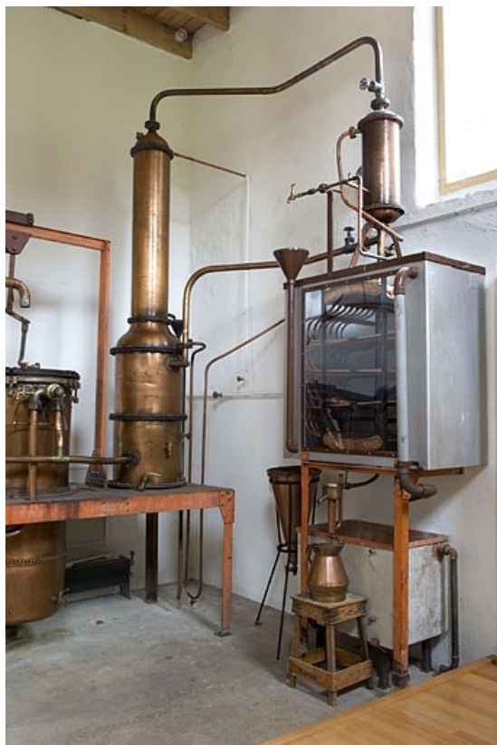
Salle de distillation. Colonnes de rectification et réfrigérant.
