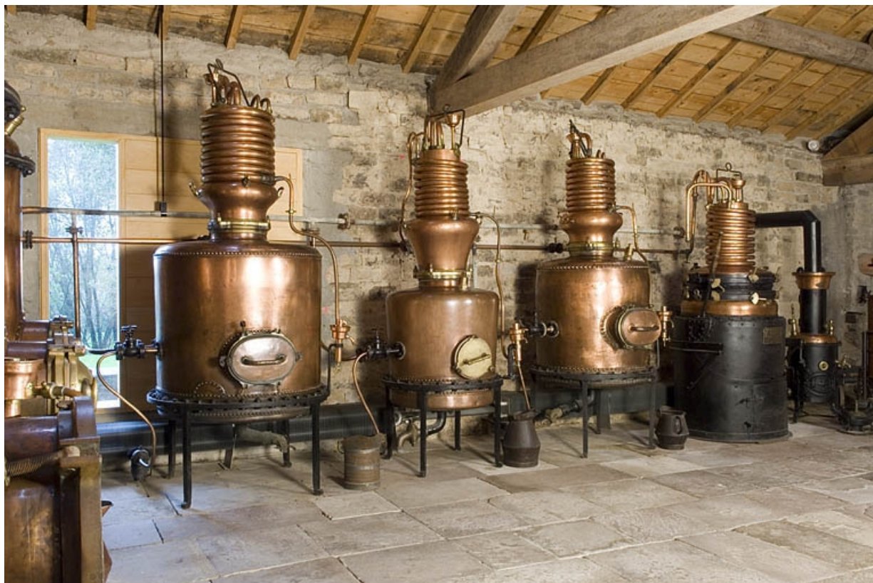
Trois alambics à vapeur provenant de la distillerie Lemercier (Prédurupt), et alambic Lepage, Urbain et Cie. 70, Fougerolles, lieudit : le Petit Fahys
