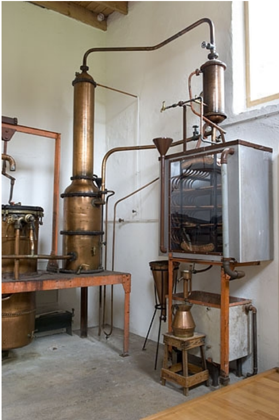
Salle de distillation. Colonne de rectification et réfrigérant.
