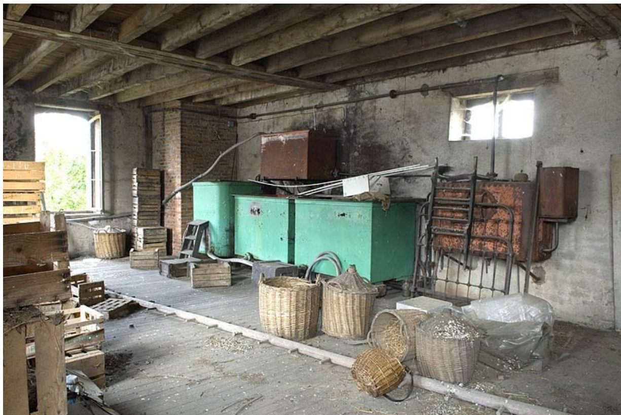
Atelier de distillation (1er étage). Chai (vieillessement des bonbonnes) et réservoirs d'eau pour bacs réfrigérants. 70, Aillevillers-et-Lyaumont, 1 rue de la Gare
