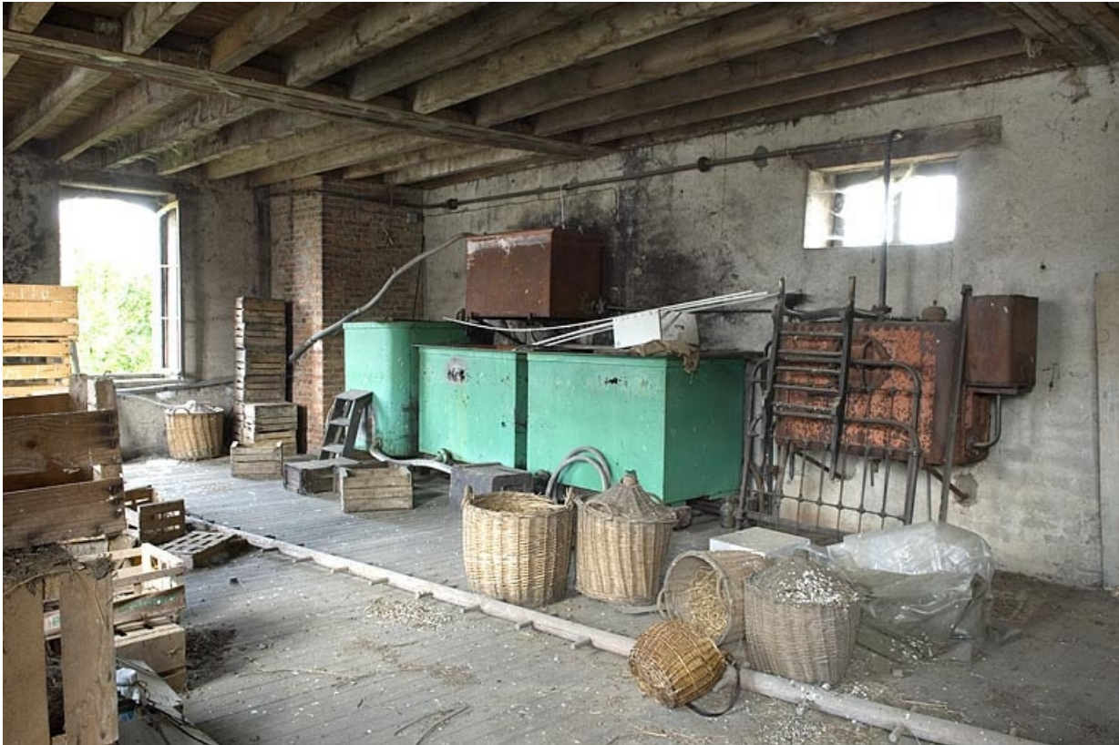
Atelier de distillation (1er étage). Chai (vieillissement des bonbonnes) et réservoirs d'eau pour bacs réfrigérants. 70, Aillevillers-et-Lyaumont, 1 rue de la Gare
