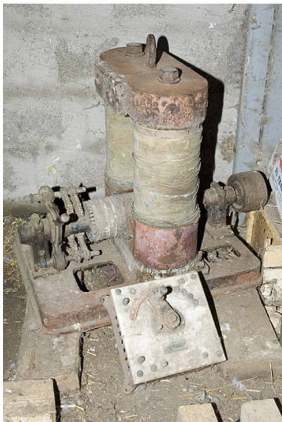
Moteur électrique Edison et tableau électrique.
