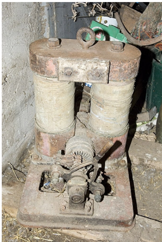
Moteur électrique Edison. Vue de face.
