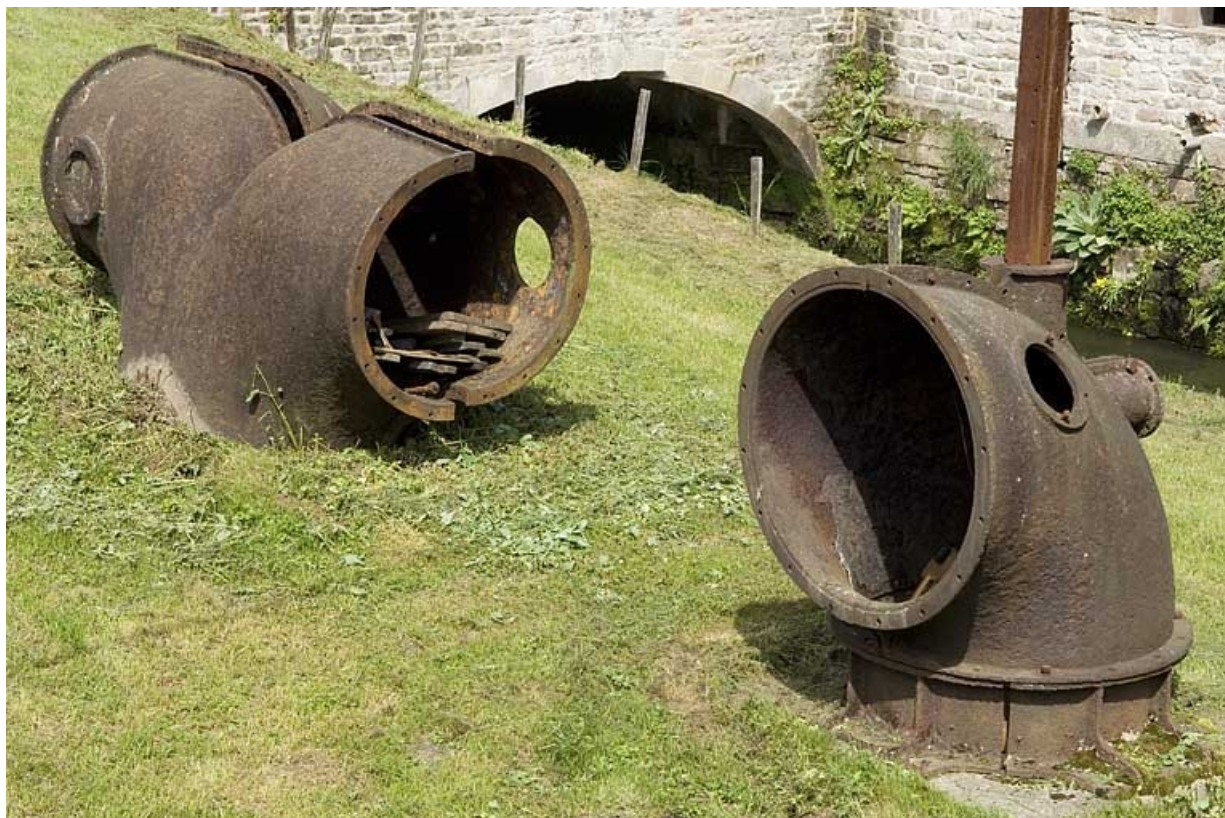
Extrémités de conduites forcées (déposées). 70, Pont-du-Bois, lieudit : la Forge
