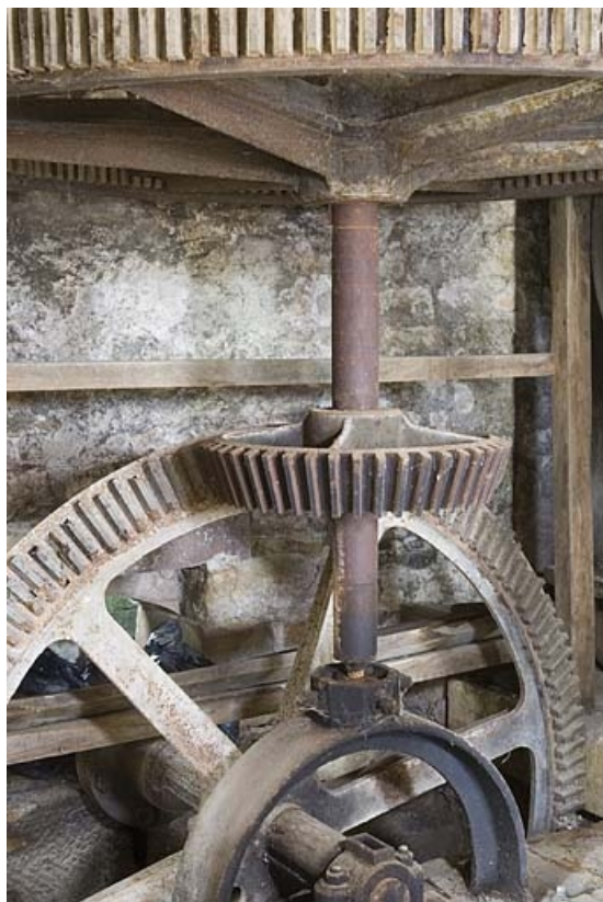
Détail des engrenages du beffroi.
