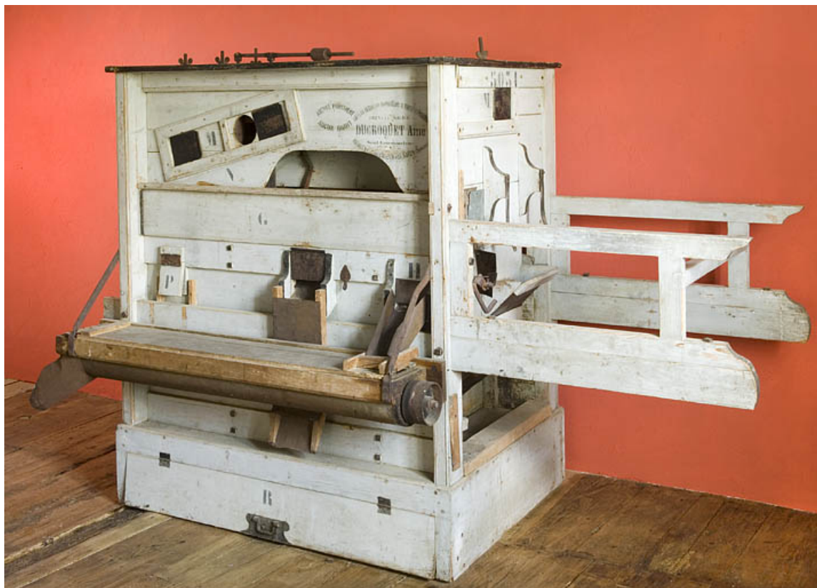
Nettoyeur-dépoussiéreur à grains. Vue de trois quarts.
