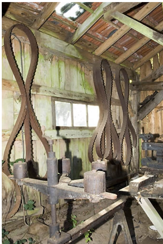
Intérieur de l'atelier d'affûtage. Lames de scie à ruban. 70, Miellin, lieudit : le Miellenot
