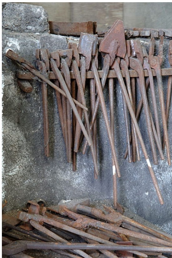
Forge du Bas. Pincés utilisées avec les martinets.
