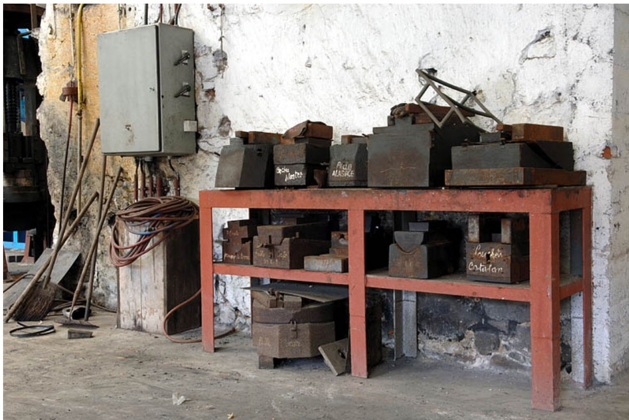
Atelier dit des Balanciers. Matrices de presses.
