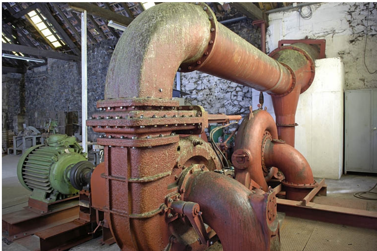
Forge du Haut. Vue rapprochée des turbines. 70, Corravillers R.D. 6, lieudit : Champs Fauvey
