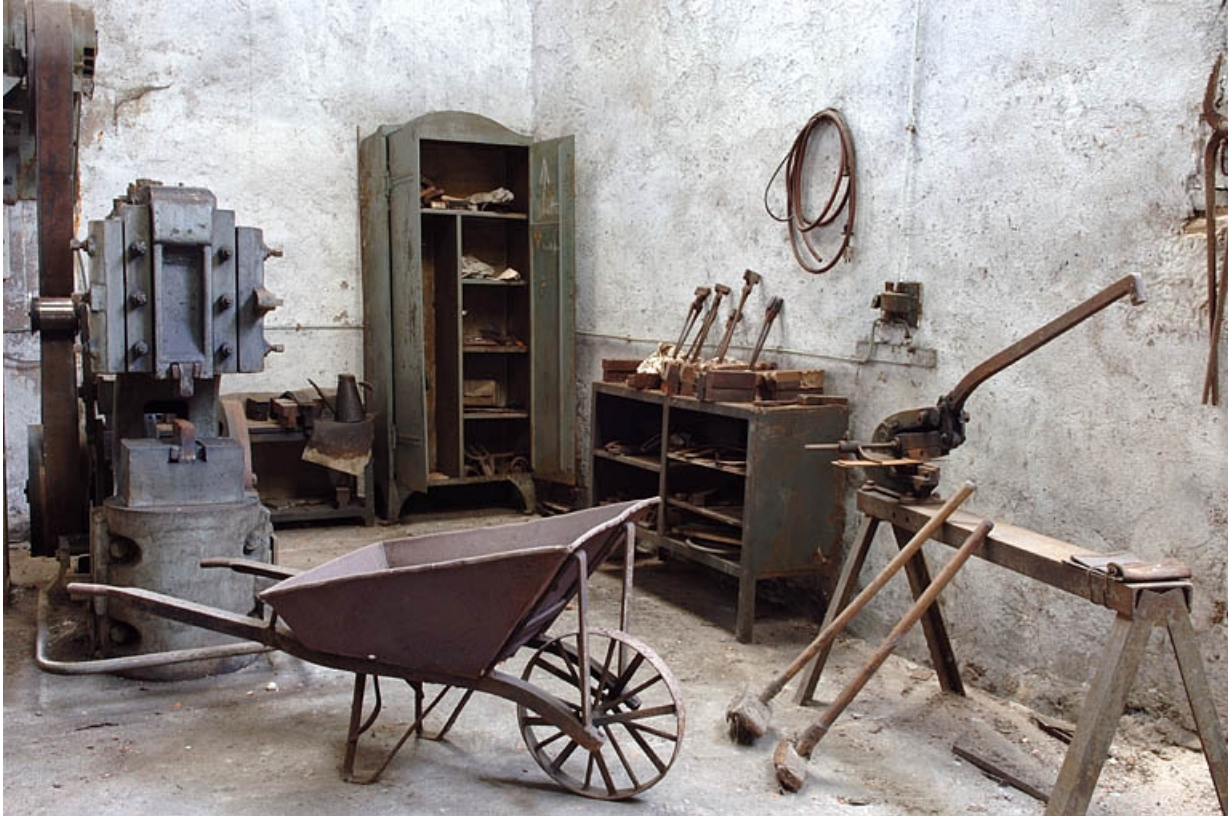
Angle ouest de la forge du Bas : martinet, armoire et casiers, brouette et cisaillon manuel. 70, Corravillers R.D. 6, lieudit : Champs Fauvey
