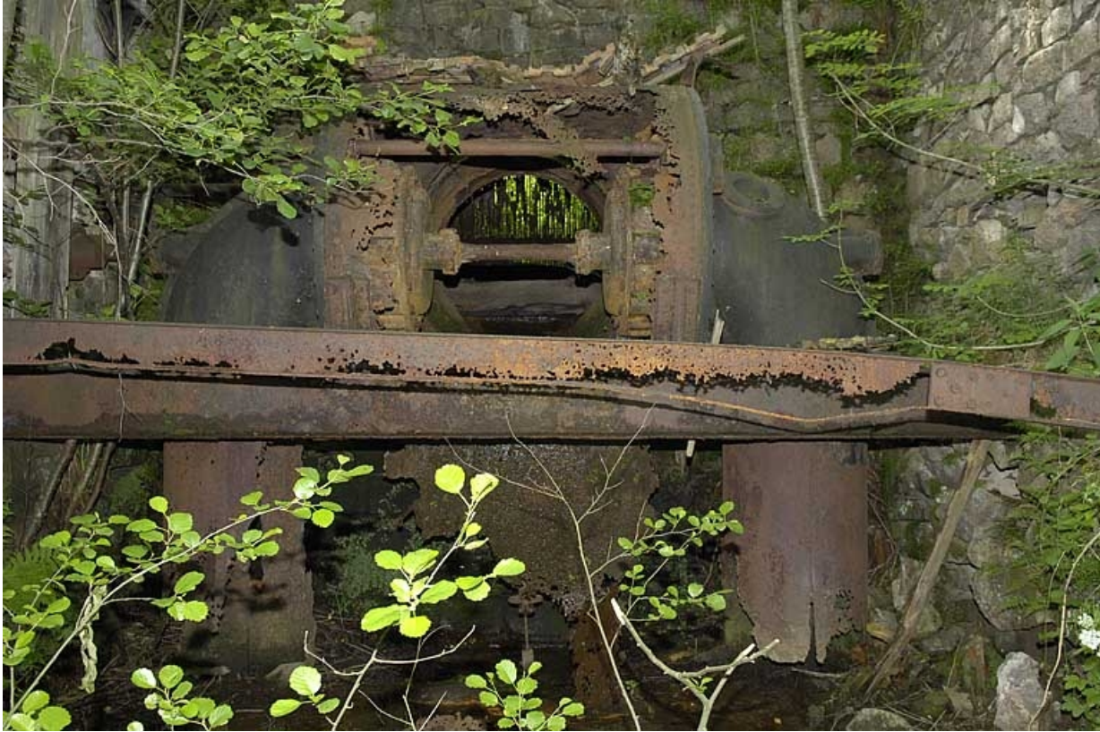
Turbine hydraulique à axe horizontal. Vue rapprochée.
