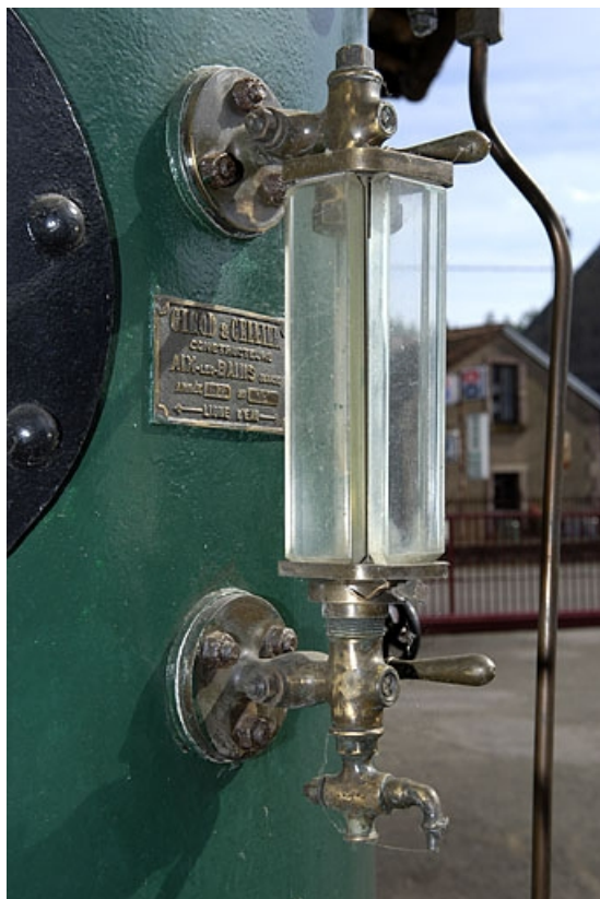
Alambic ambulant. Détail de la chaudière.
