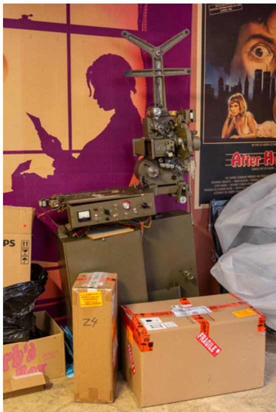
Cabine de projection : projecteur argentique Cinémeccanica (n° D 15188). 58, Decize rue des Halles
