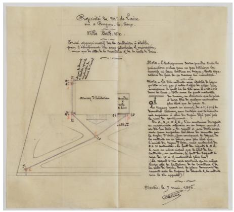
Plan-masse portant un projet de conduites à établir pour l'écoulement des eaux pluviales et ménagères. 58, Pouques-les-Eaux, 93 avenue de Paris
