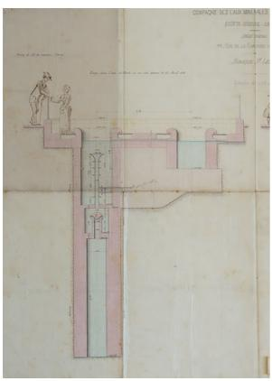
Coupe sur les deux puits avant et après l'abaissement du niveau de l'eau survenu fin avril 1891, détail de l'état antérieur. 58, Pougues-les-Eaux, 23-25 avenue de Conti
