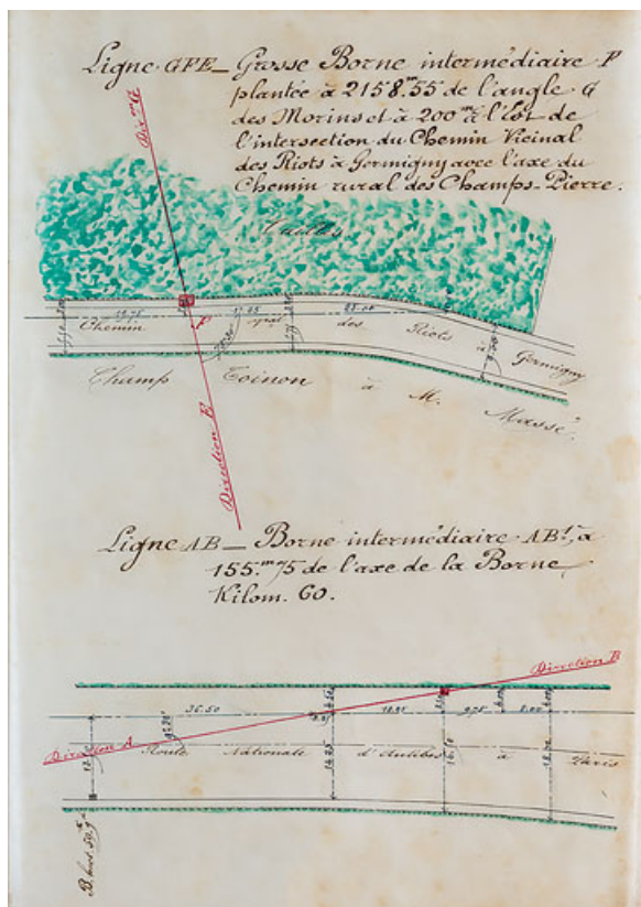
Plan de la position des bornes, bornes intermédiaires F et AB1.
