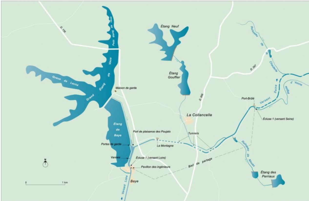
Carte schématique du bief de partage et des étangs-réservoirs qui l'alimentent.
