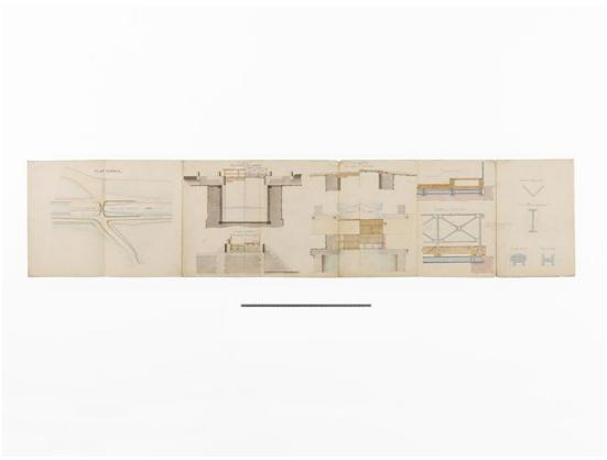
"Projet de remplacement du tablier en charpente par un tablier métallique. Pont sur l'écluse de Marré n°10". Plan général, élévations et coupe du pont actuel et du pont projeté. Détail des garde-corps en métal. (Dessin ; 7 feuilles de 21 x 31 cm ; juillet 1874, Archives VNF-direction territoriale Centre-Bourgogne ; subdivision de Corbigny)
