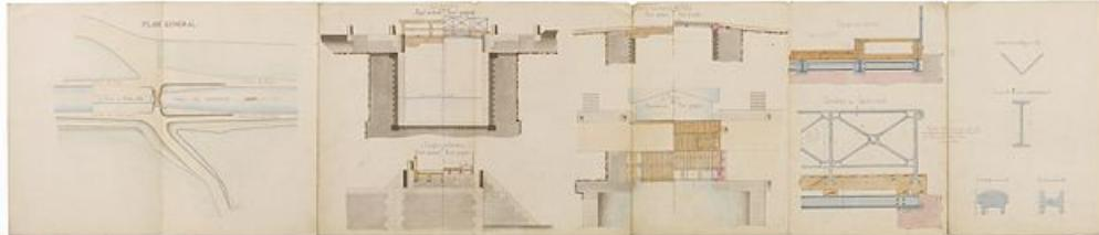
**"Projet de remplacement du tablier en charpente par un tablier métallique. Pont sur l'écluse de Marré n°10". Plan général, élévation et coupe du pont actuel et du pont projeté. Détail des garde-corps en métal. (Dessin ; 7 feuilles de 21 x 31 cm ; juillet 1874, Archives VNF-direction territoriale Centre-Bourgogne ; subdivision de Corbigny)**
