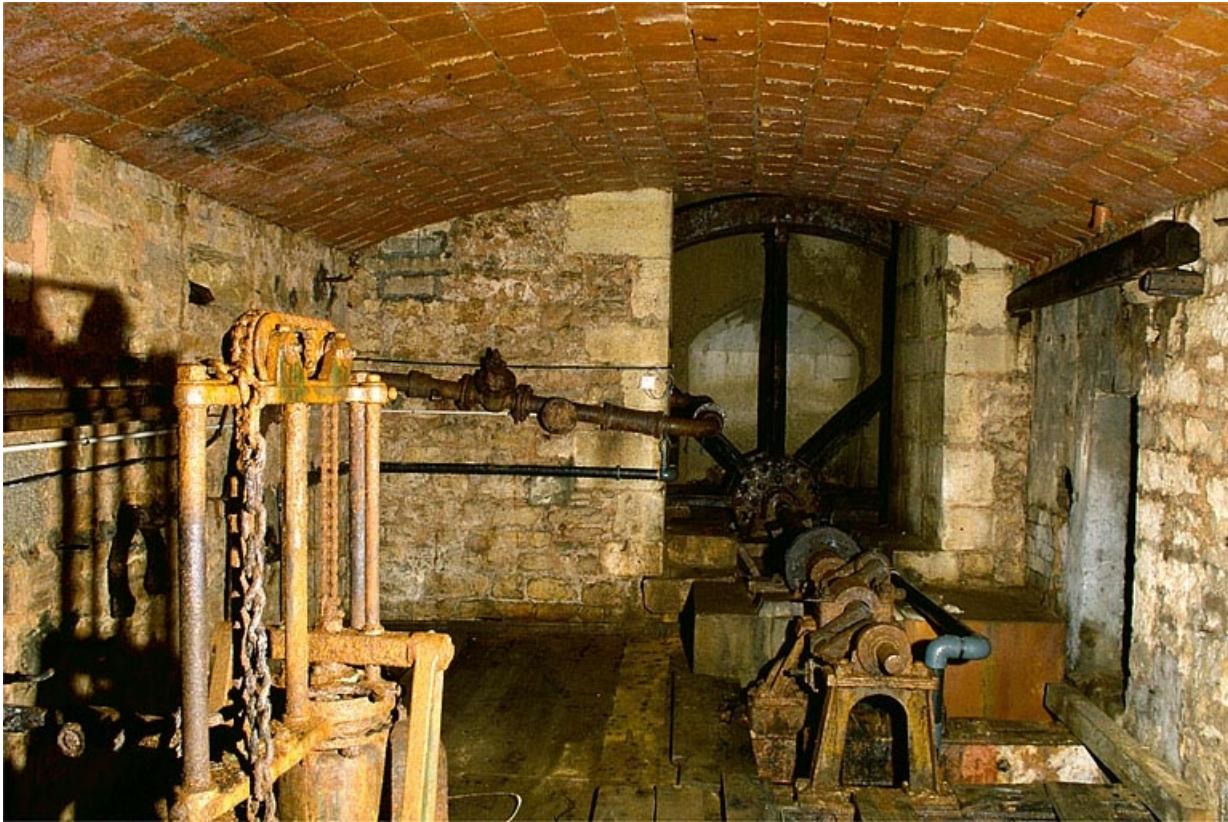
Plancher supérieur du puits à Muire. La roue hydraulique, visible au fond, actionnait une pompe située au fond du puits. 39, Salins-les-Bains, 2 place des Alliés et de la Résistance
