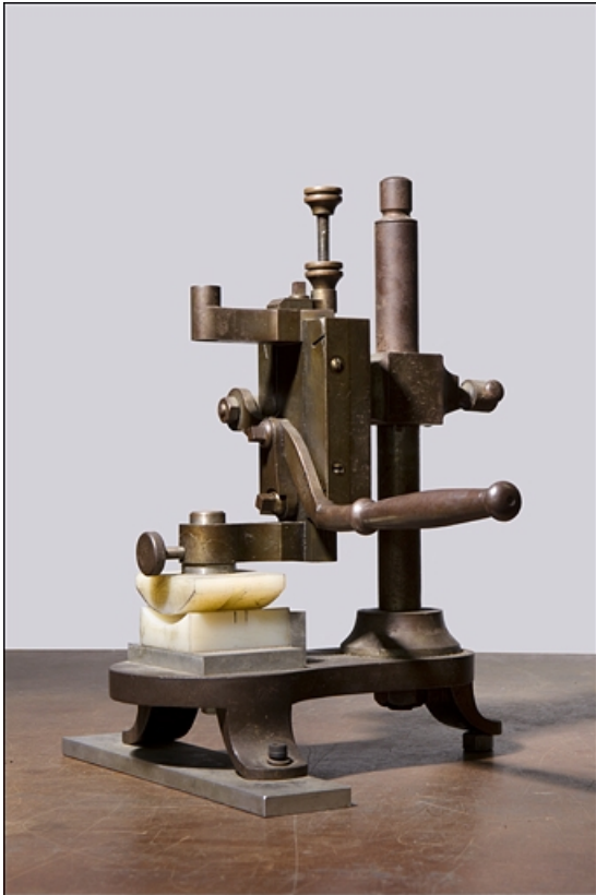
Machine à cintrer les faces, à coulisseau vertical (détournée).
