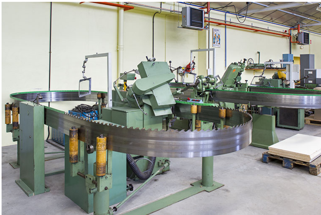
Scierie : détail des machines à affûter les lames de scie.
