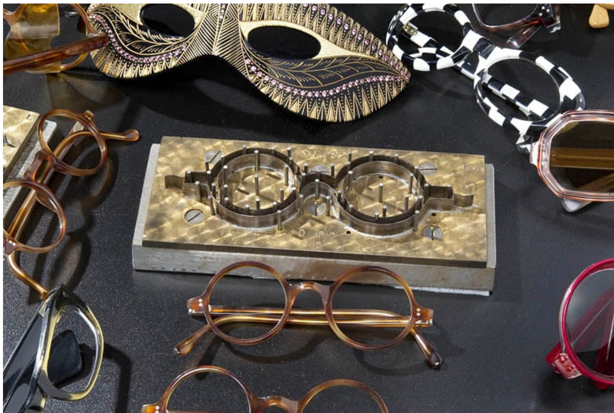
Lunettes en plastique et emporte-pièce ayant servi à leur fabrication. Modèle de lunettes courant jusqu'à la première guerre mondiale. Collection du musée de la Lunette, Morez.
