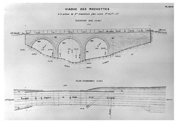
Viaduc des Rochettes à 3 arches de 8 m d'ouverture plein-cintre. Plan d'ensemble [et] Elévation aval, [1919]. 39, La Rixouse, lieudit : sous les Rochettes
