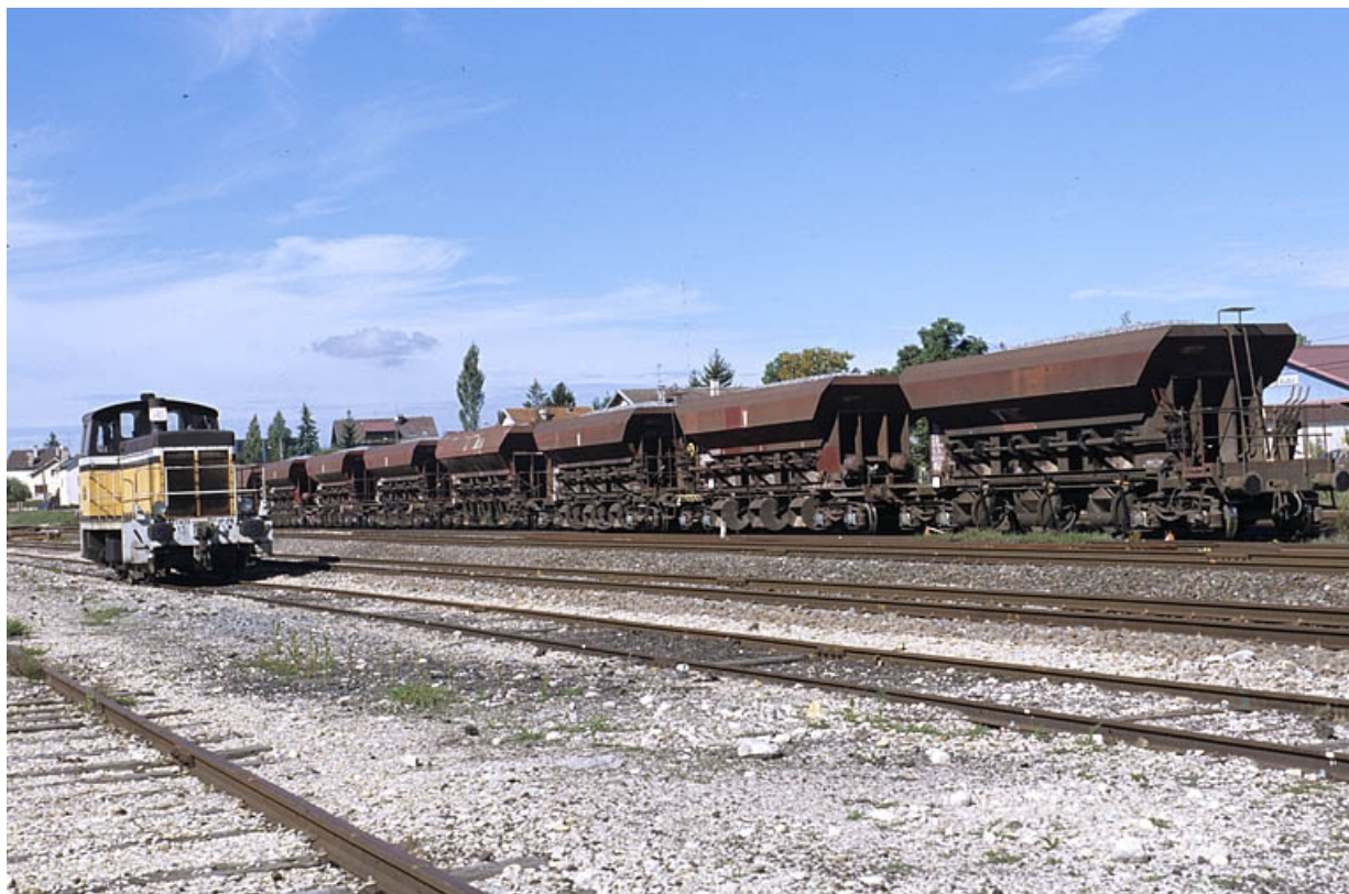
Locomotive diesel Y 7400 (n° Y 7435) et wagons-trémies.
