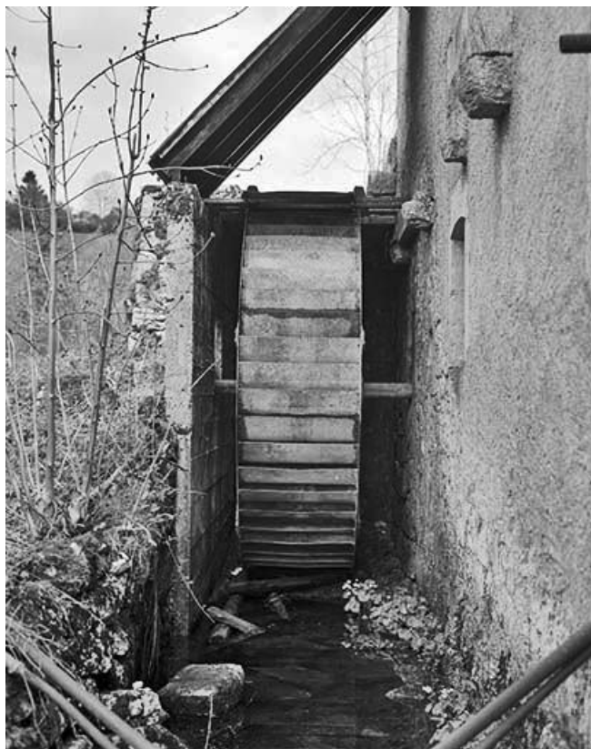
Roue à aubes ou à " augets ".
