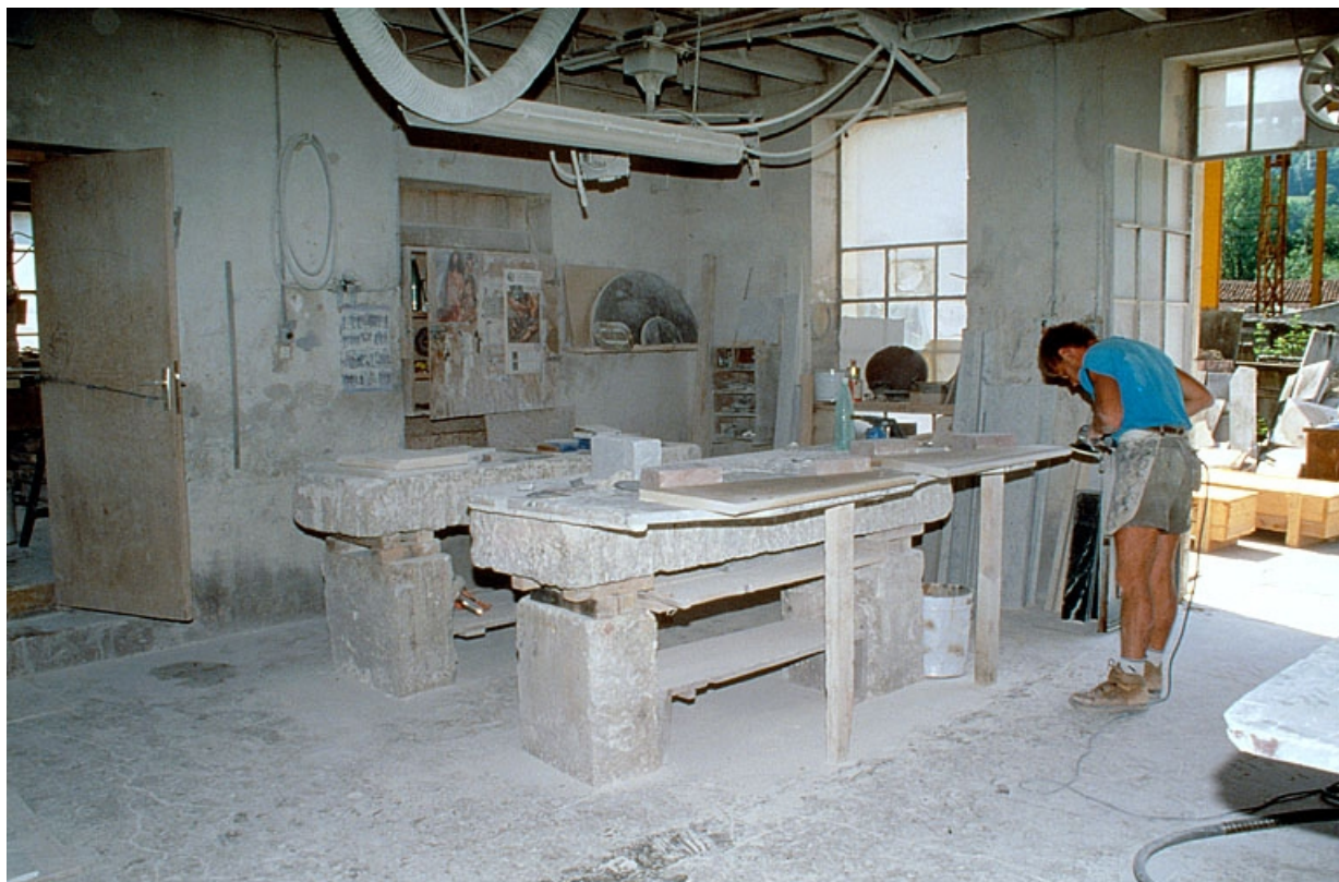
Polissage du chant d'une marche d'escalier à l'aide d'une meuleuse.
