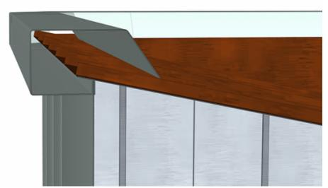
Restitution du système constructif : coupe au niveau de la corniche, avec toiture.
