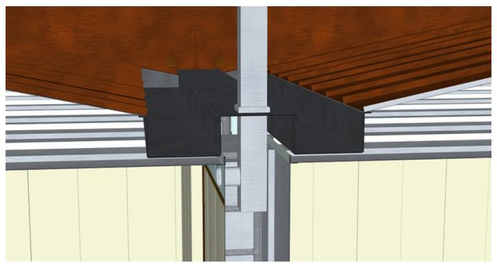
Restitution du système constructif : coupe au niveau de la noue centrale, avec cheminée, plafond et toiture. 39, Saint-Amour, 23 rue d' Allonal
