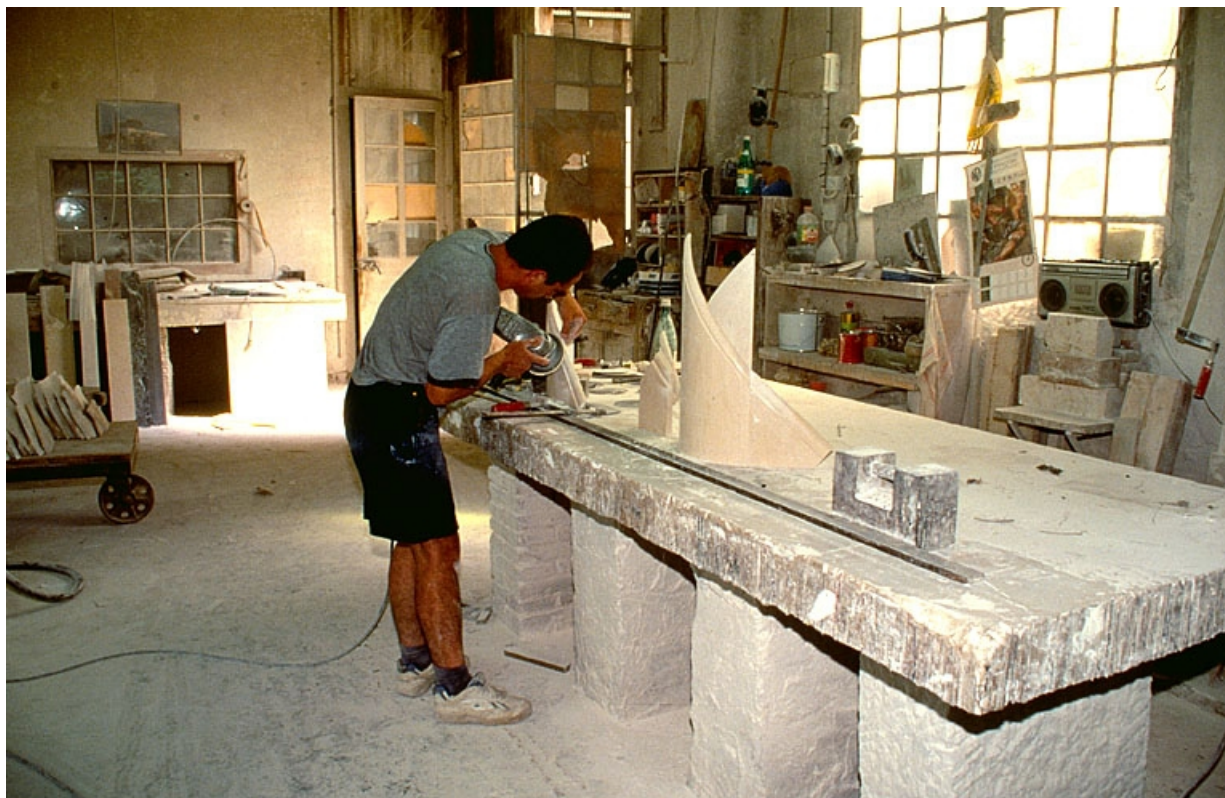
Polissage d'un limon d'escalier.
