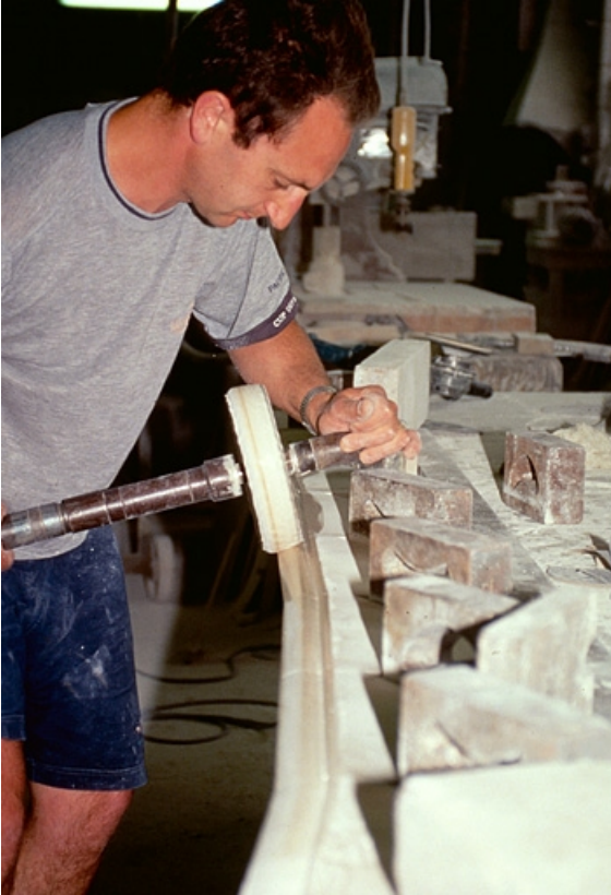
Polissage d'un limon d'escalier.
