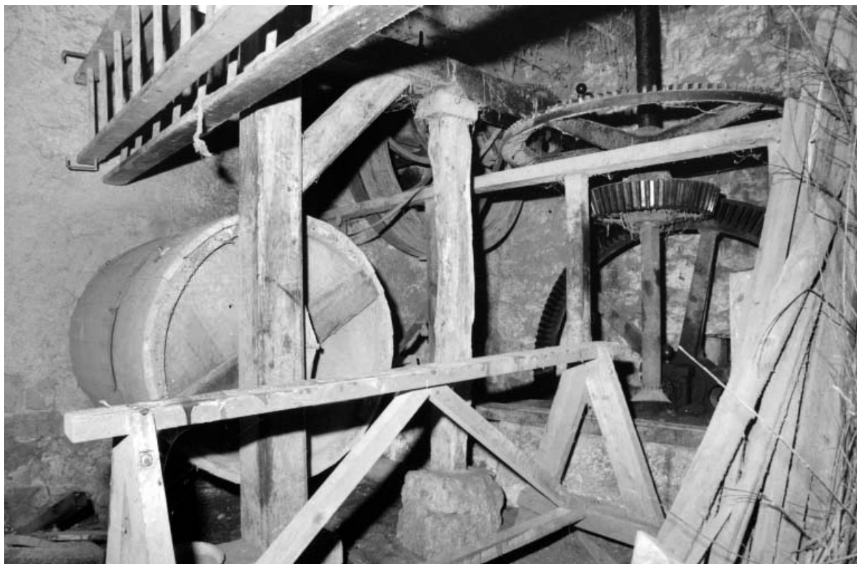
Tonneau de polissage et transmission.
