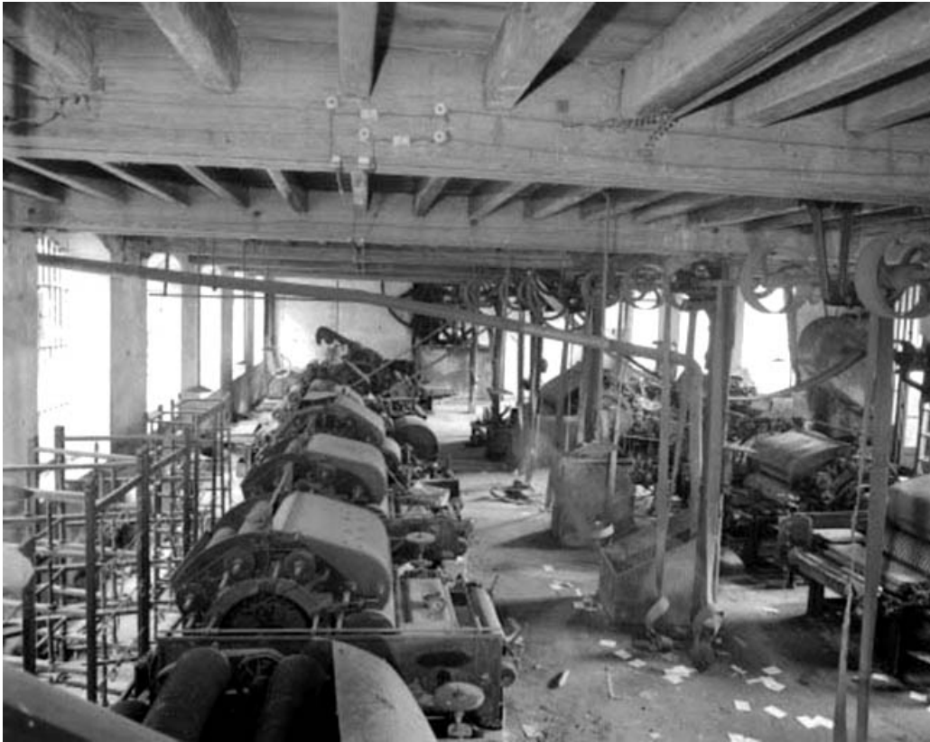
Intérieur de l'atelier de cardage (rez-de-chaussée du bâtiment J).
