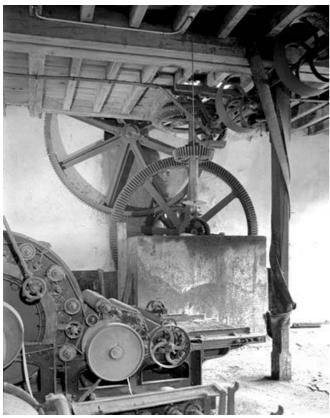
Transmission de la grande roue hydraulique.
