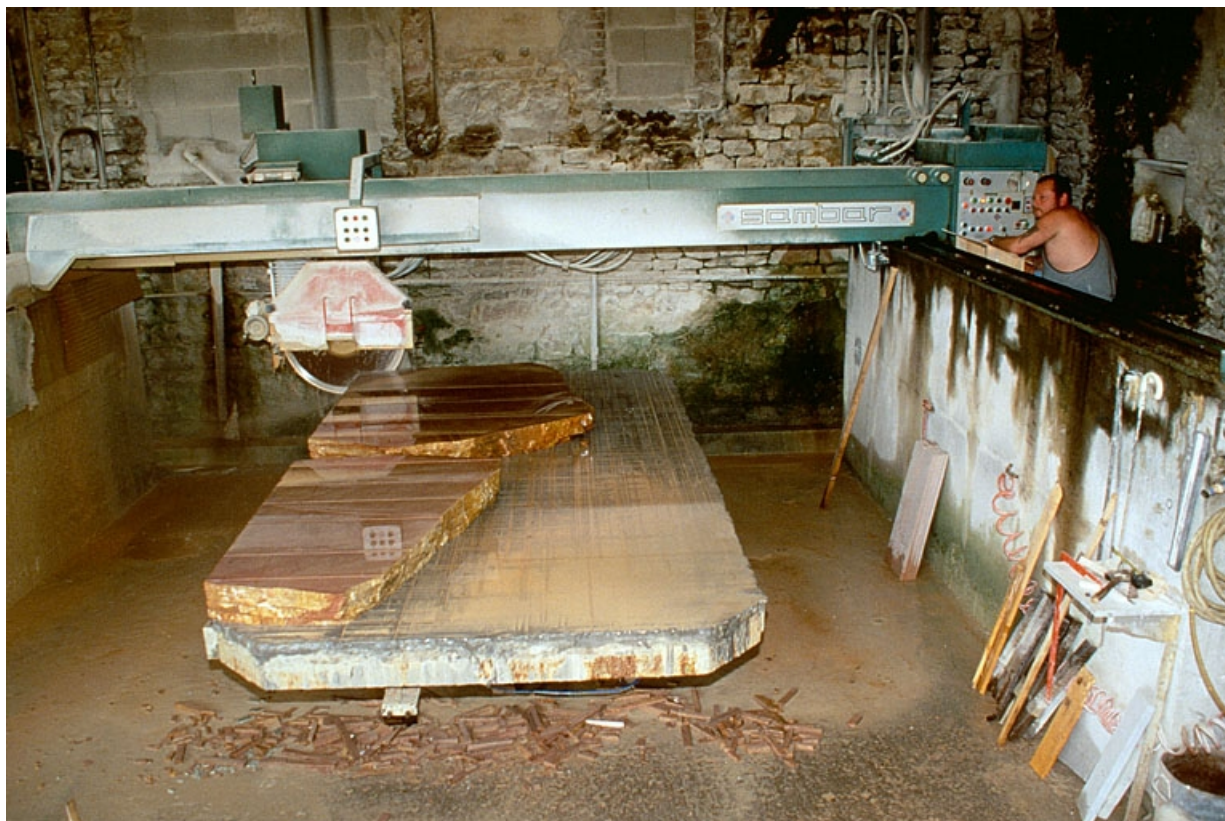
Débiteuse Gregori en cours de sciage : vue d'ensemble. 39, Balanod
