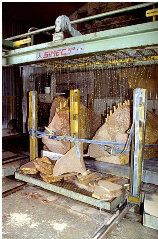
Châssis multilames Simec : vue de détail de trois quarts gauche.
