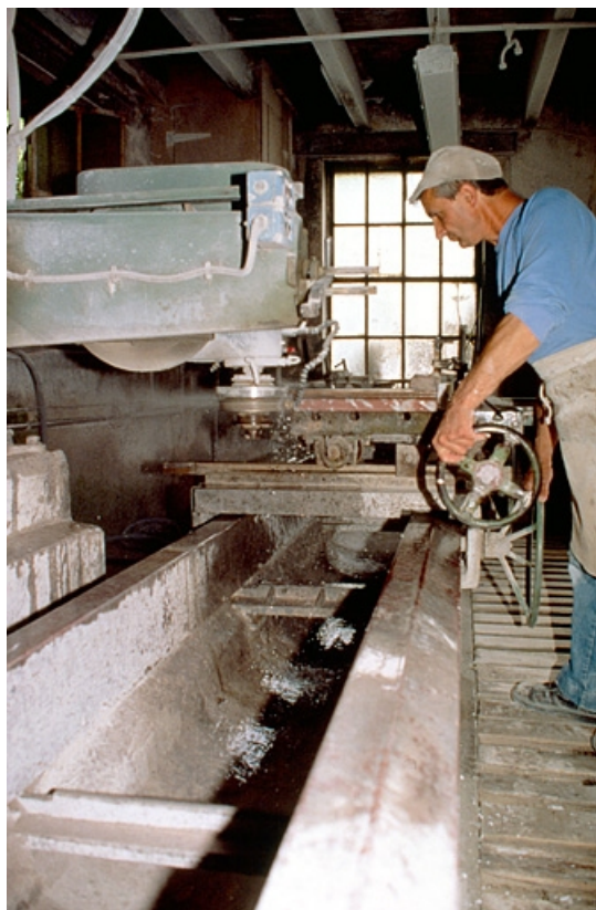
Moulurage d'une plaque de marbre.
