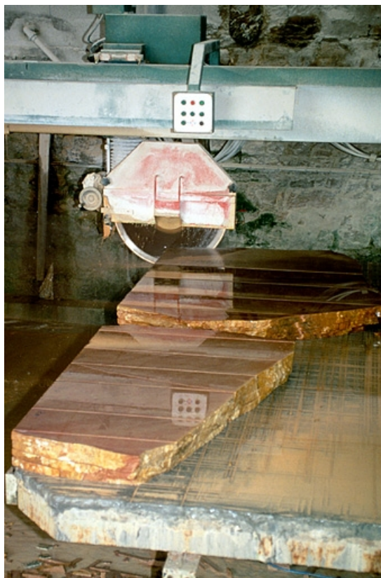
Débiteuse Gregori en cours de sciage : vue de détail. 39, Balanod
