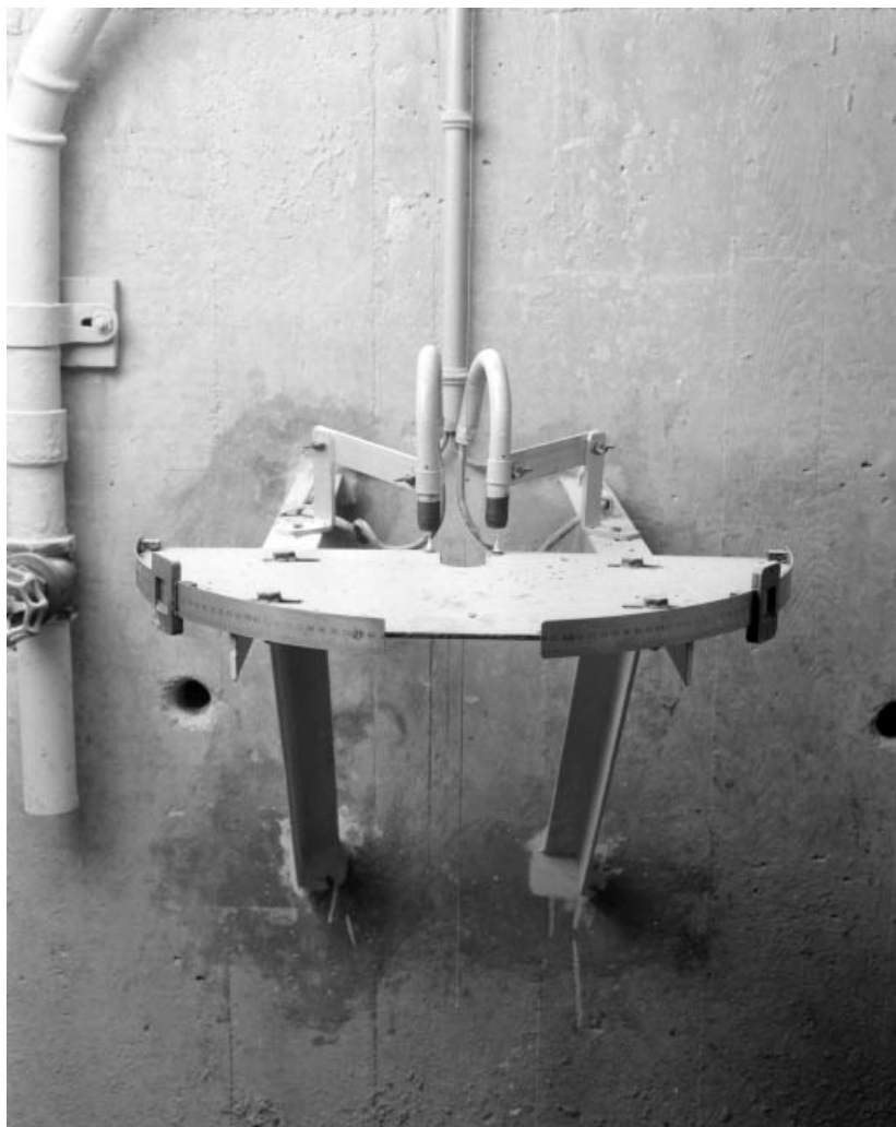
Système d'auscultation du barrage : table de lecture du pendule.
