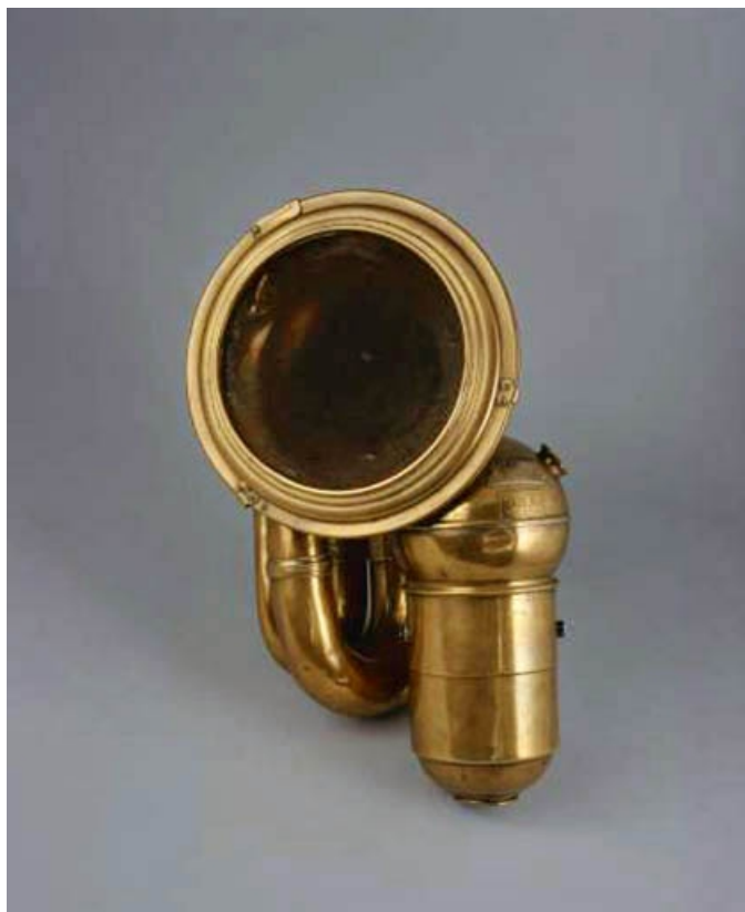
Avertisseur sonore pneumatique pour automobile.
