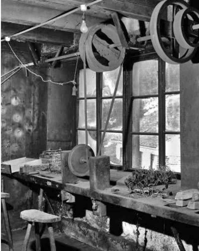
Intérieur : tour à polir et transmission.
