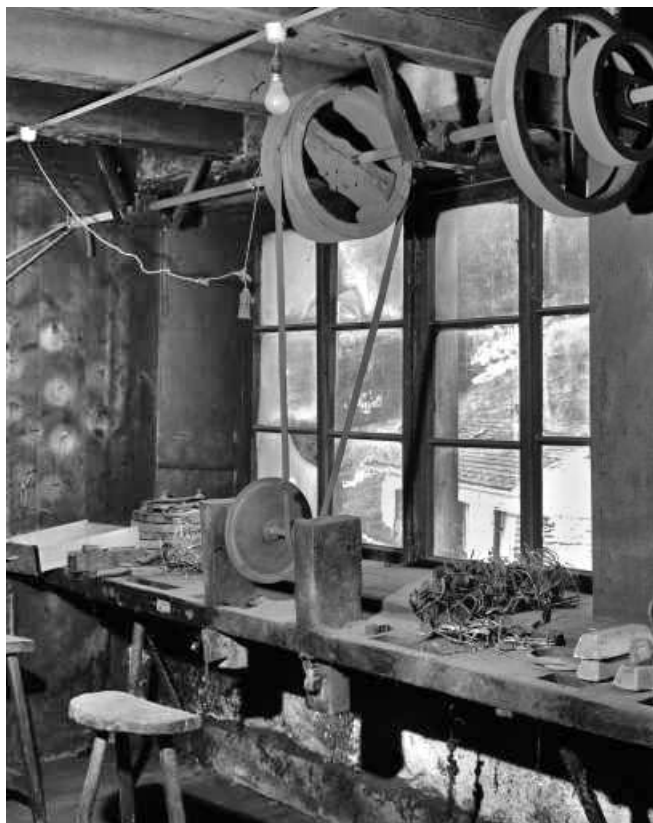
Intérieur : tour à polir et transmission.
