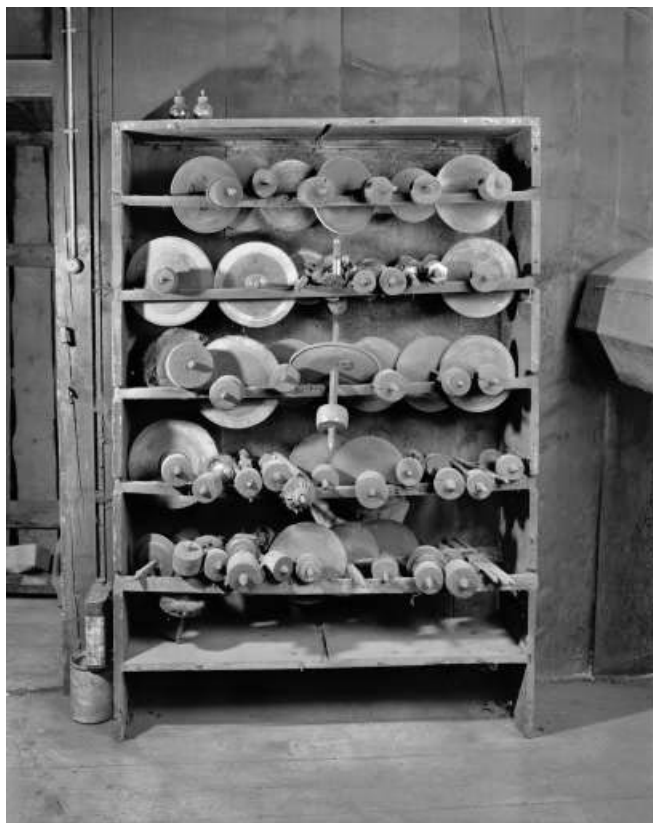
Intérieur : disques à polir.
