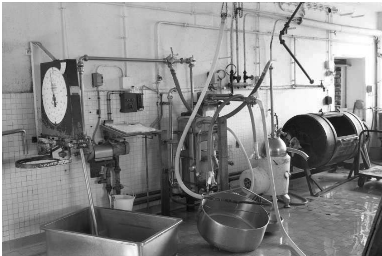
Atelier de fabrication : pèse-lait, écrémeuse et baratte.
