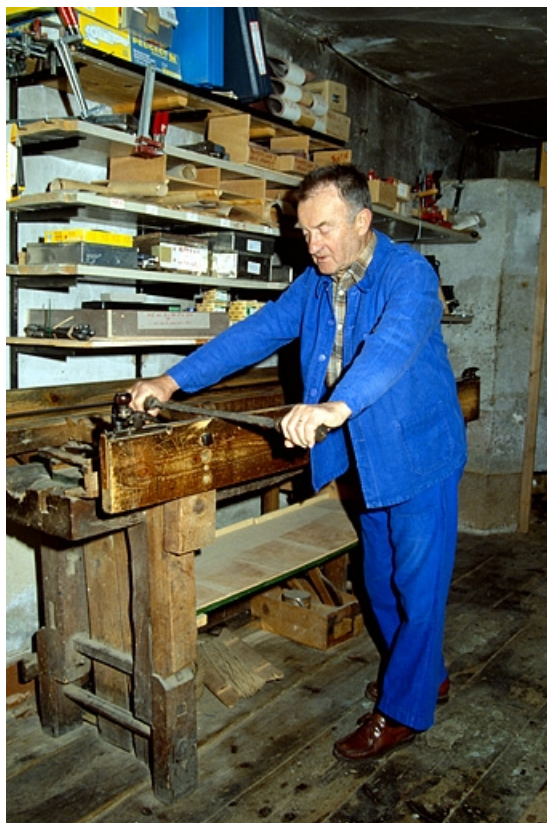
Décapage d'une bande de métal (sur le banc à racler). 39, Longchaumois Grande Rue 26
