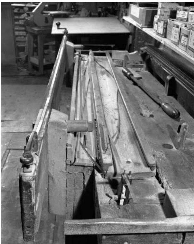
Banc à racler : système de fixation de la lame à gauche, système d'ébarbage au premier plan.
