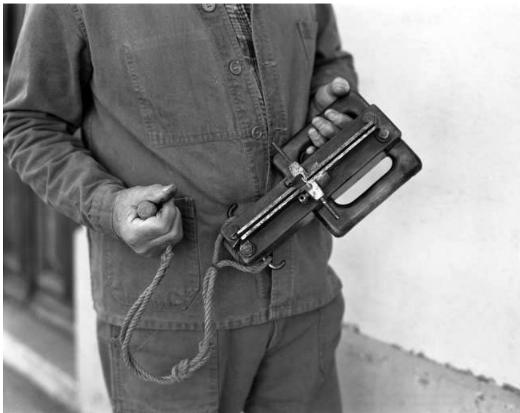
"Rabot" à découper, face inférieure.
