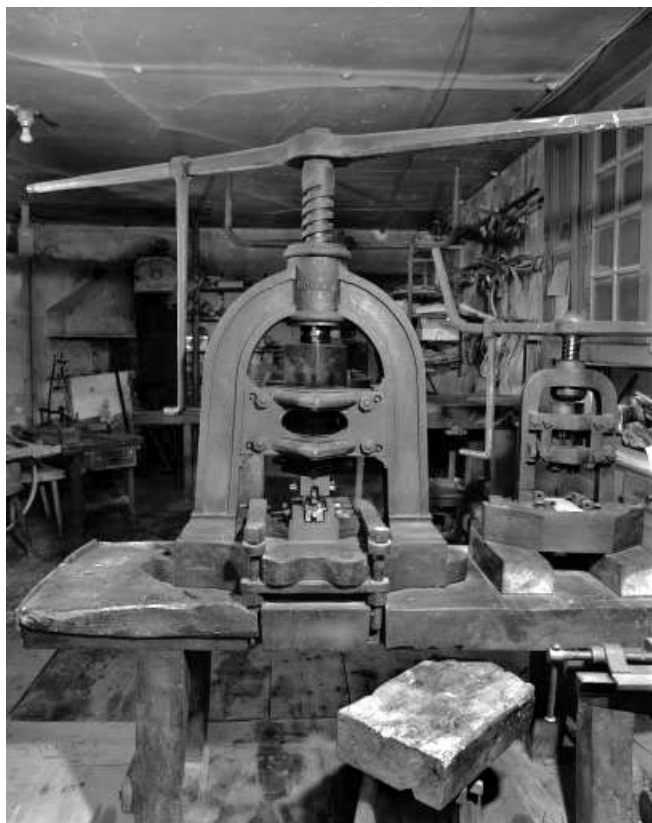
Détail de la grande presse à vis à balancier et de son poinçon. 39, Longchaumois Grande Rue 26
