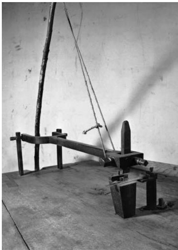
Banc à poinçonner : système de poinçonnage.
