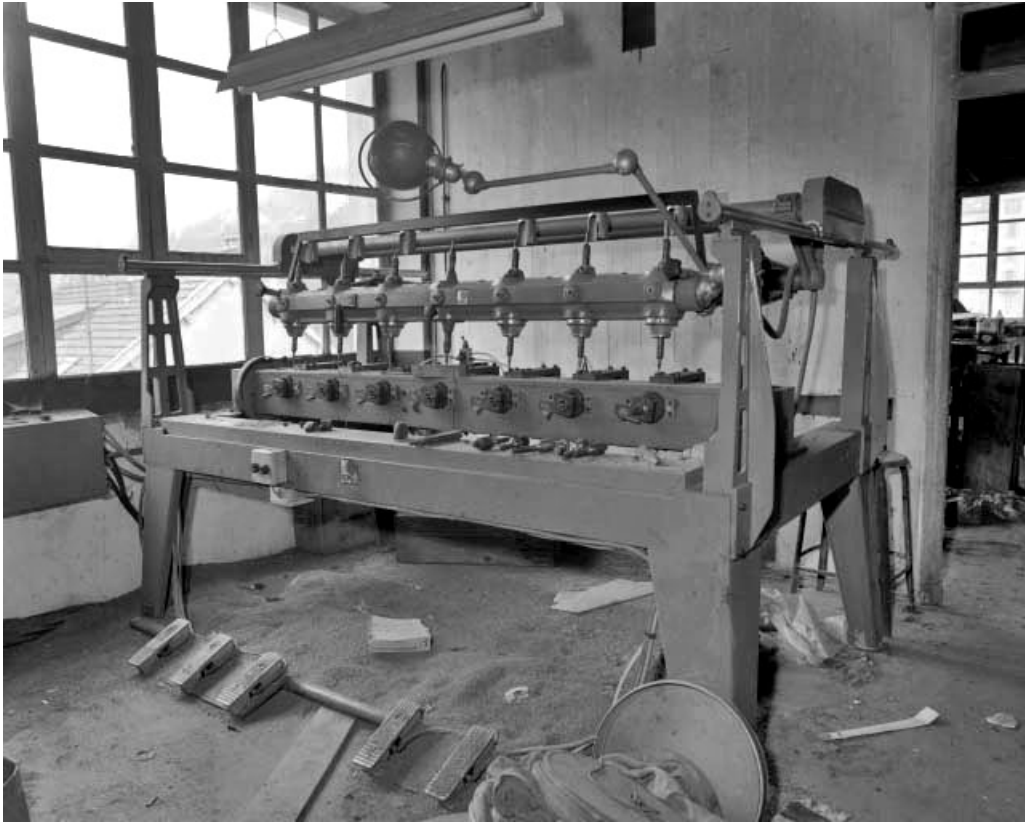
Machine à sculpter et à râper ACIMALL "la Scolpitrice". Pantographe avec palpeur central et 6 fraises. 39, Saint-Claude, 12, 14 rue de Bonneville
