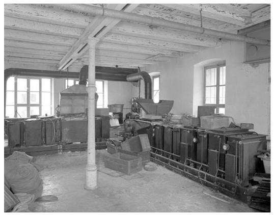
Atelier de fabrication (rez-de-chaussée) : chaîne d'électrolyse.
