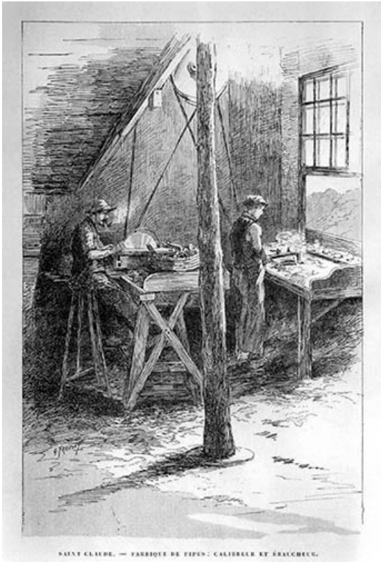
SAINTE-CLAUDE. — FABRIQUE DE PIPES : CALIBREUR ET ÉBAUCHEUR.
