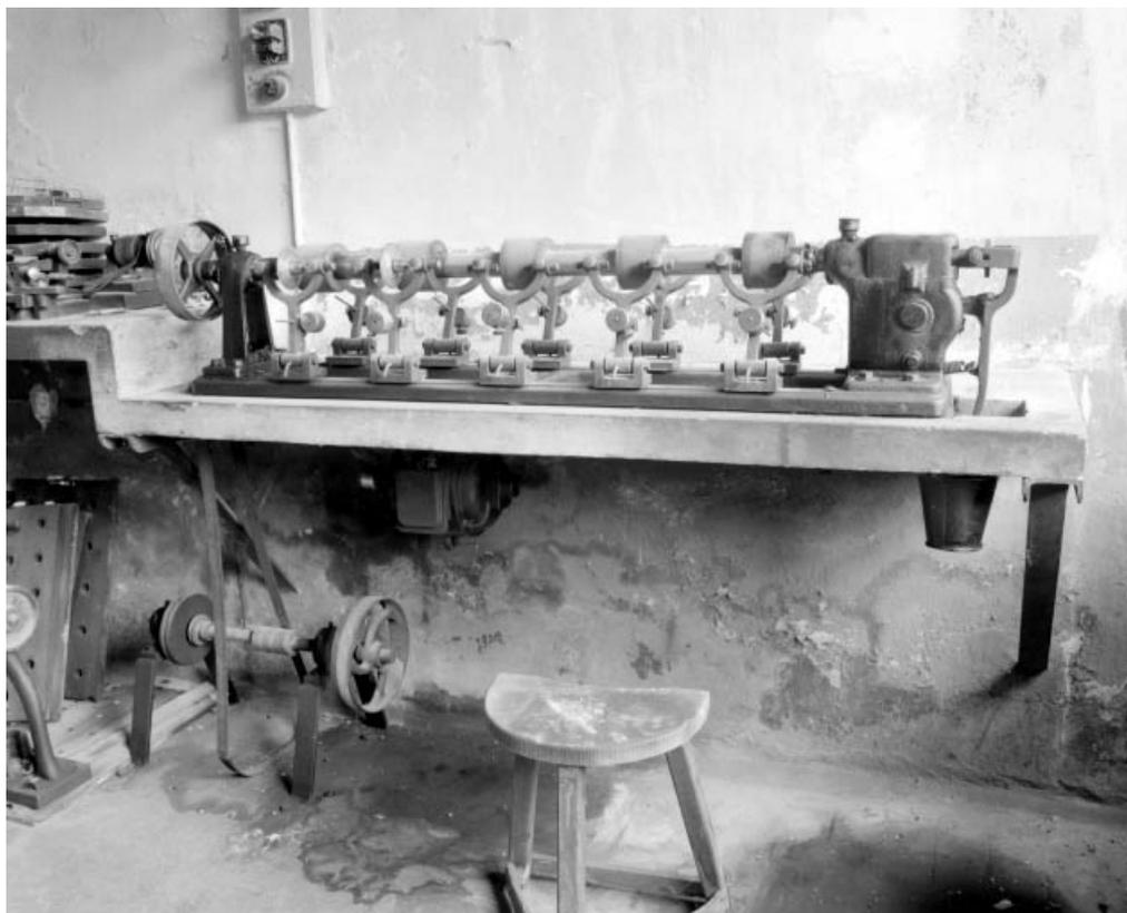
**Machine à diamanter les lames de scie.**
