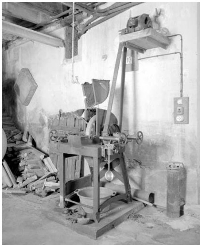
Machine à "roder" (rectifier) les meules de diamantaire.
