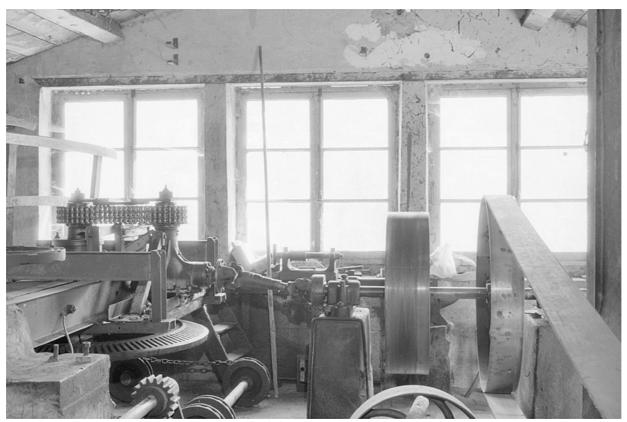
Transmission entre la turbine et la dynamo.
