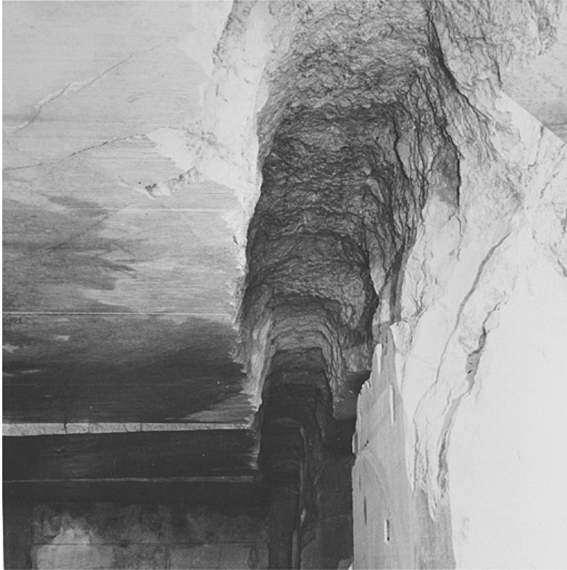
Intérieur de la carrière : tunnel pour le passage du fil hélicoïdal au plafond.
