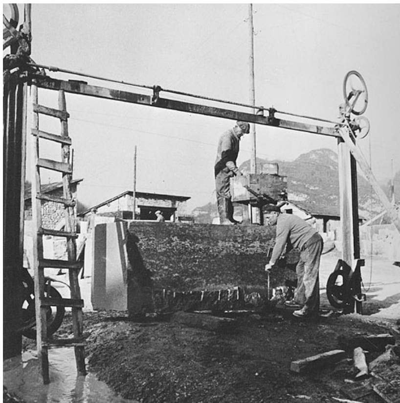
Suppression des aspérités sur la face d'un bloc taillé au fil hélicoïdal.
