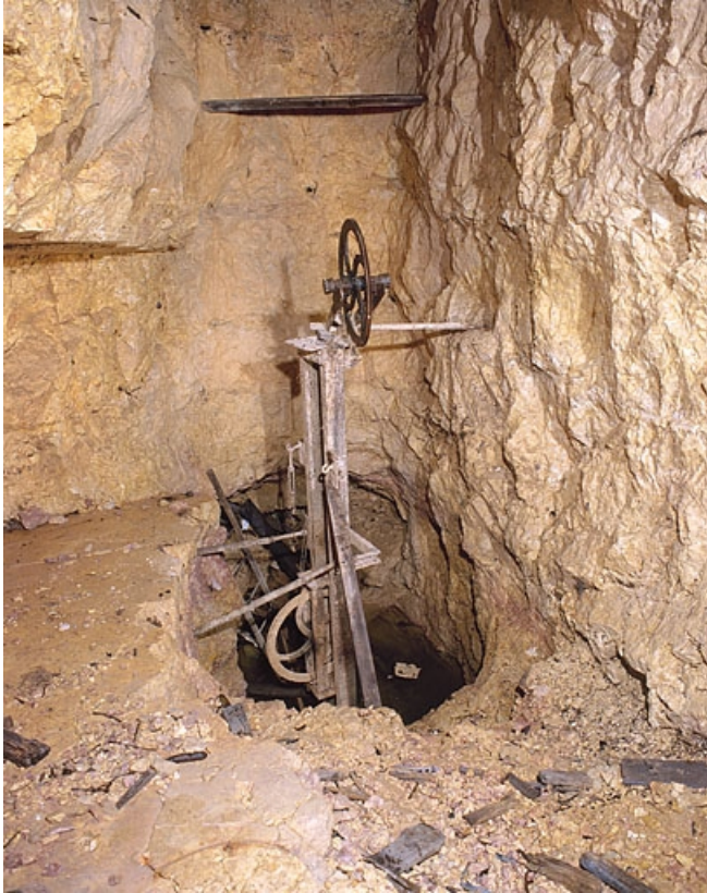
Intérieur, partie centrale, poulies de renvoi du fil hélicoïdal.
