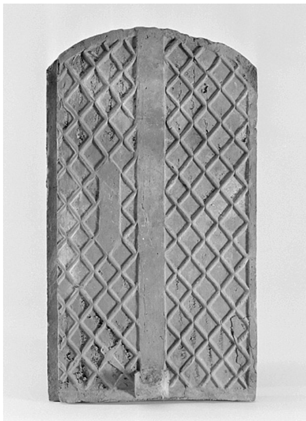
Face intérieure d'une tuile-écaille.
